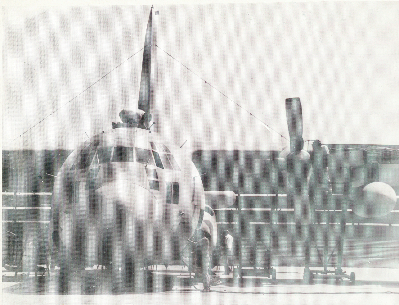
Samoloty Lockheed C-130 Hercules są modyfikowane przez Lockheed Aircraft Service Company (LAS) do wersji walki elektronicznej (EW), dowodzenia i łączności (C3) i innych specjalistycznych
