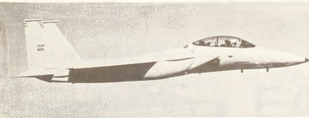
F-15B nr 10291 z podwieszonymi Conformal Fuel Pallets (konforemnymi zbiornikami paliwa), podczas jednego z próbnych lotów w sierpniu 1974 r.
