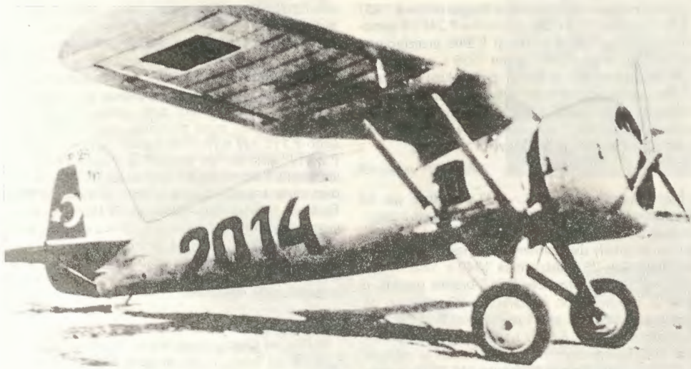
PZL P.24A z nr. 2014 w Turcji, z chłodnicą na prawym boku kadłuba (ze zbiorów J. Cynka)
