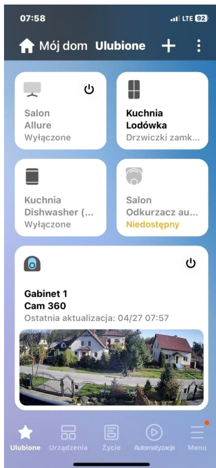
Rys. 2. Panel monitora automatyki budynku w systemie SmartThings
