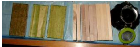
Rys. 7. Proces barwienia drewna gotowym odwarem z pokrzywy
