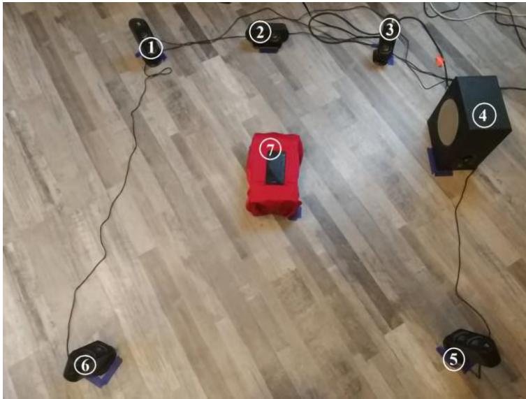
Rys. 3. Schemat rozmieszczenia elementów stanowiska badawczego: 1 – lewy przedni głośnik, 2 – głośnik centralny, 3 – prawy przedni głośnik, 4 – subwoofer, 5 – prawy tylny głośnik, 6 – lewy tylny głośnik, 7 – miejsce ustawienia przyrządów pomiarowych
