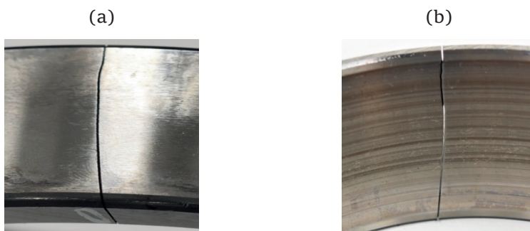
Rys. 2.6. Pęknięcie pierścienia zewnętrznego łożyska stożkowego: widok od strony zewnętrznej (a) oraz widok od strony bieżni (b)
