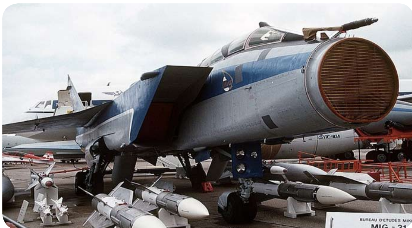
Samolot myśliwski MiG-31 z pociskami powietrze-powietrze R-33. Widoczna płaska antena radaru fazowego ZASŁON składająca się z kilkuset małych anten, których sygnały są sumowane przez komputer i mogą być kontrolowane oddzielnie [38] (Wikipedia)
