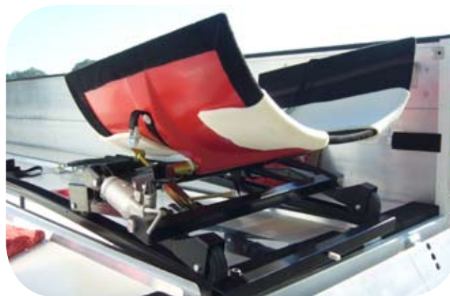
Rys. 8. Profilowana podpora skrzydła z miękką wyściółką w przyczepie
