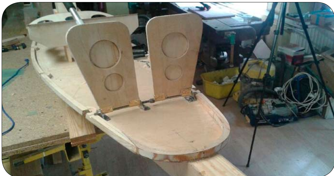
Rys. 9. Pedaty steru kierunku. Fot. Jerzy Gruchalski
