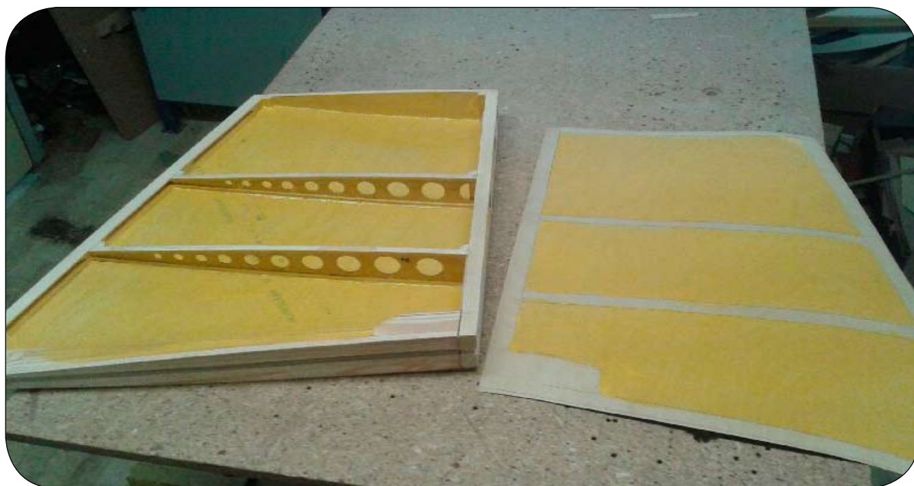
Rys. 7. Statecznik pionowy przed sklejeniem. Fot. Jerzy Gruchalski
