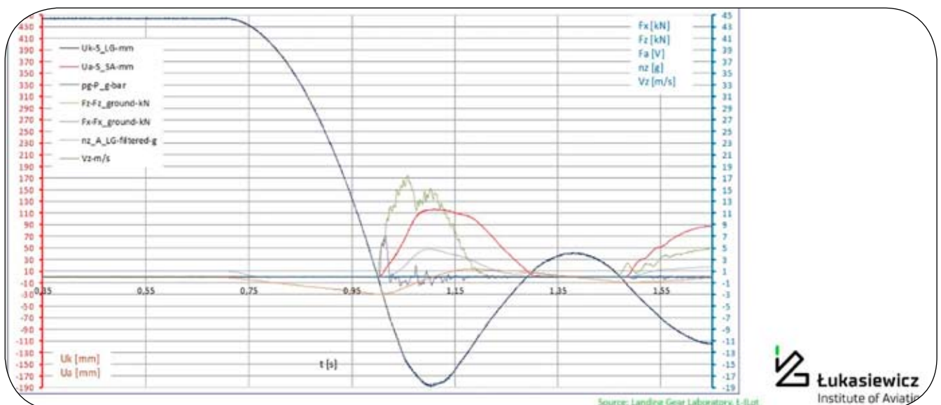
Rys. 10. Wyniki badań podwozia przedniego samolotu I-23 Manager na stanowisku zrzutowym Instytutu Lotnictwa w Warszawie
