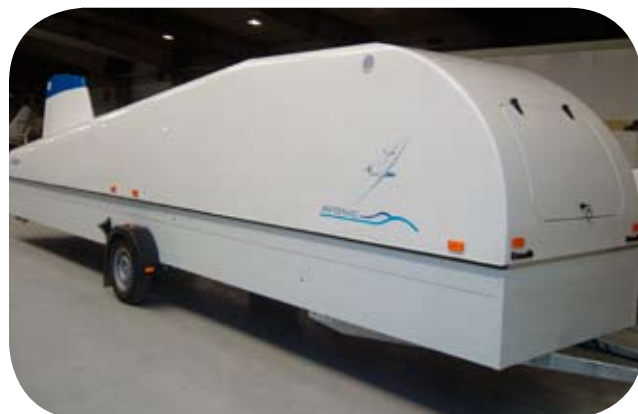
Rys. 12. Przyczepa AVG produkcji Avionic, wykonana dla odbiorcy zagranicznego z uwzględnieniem specjalnych wymogów technicznych
