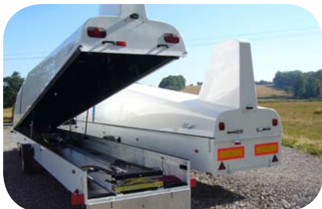
Rys. 5. Pokrywa podnoszona, uniesiona i opuszczona do pozycji transportowej
