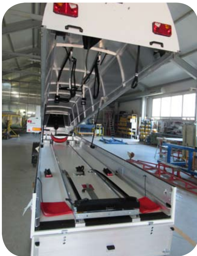
Rys. 19. Przyczepa Taurus do przewozu szybowców i motoszybowców dwumiejscowych
