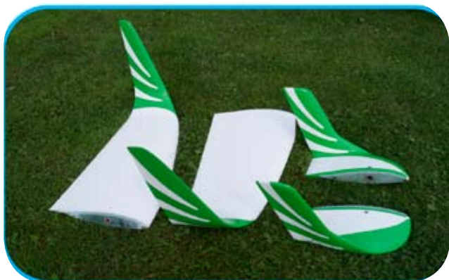
Rys. 5. Zestaw wymiennych końcówek skrzydłowych do Jantarów – 15 m i 17 m
