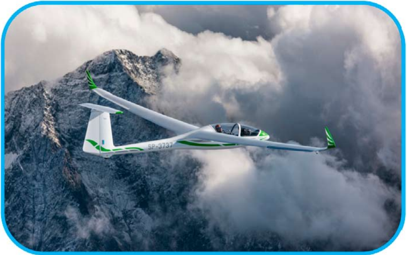
Rys. 7. Zmodyfikowana do 17 m wersja SZD-48-1 „Jantar Std 2” o oznaczeniu SZD-48-4 „Jantar 17”. Fot. Jakub Świsł
