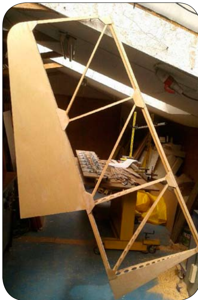
Rys. 2. Gotowy ster kierunku Czajki II. Fot. Jerzy Gruchalski
