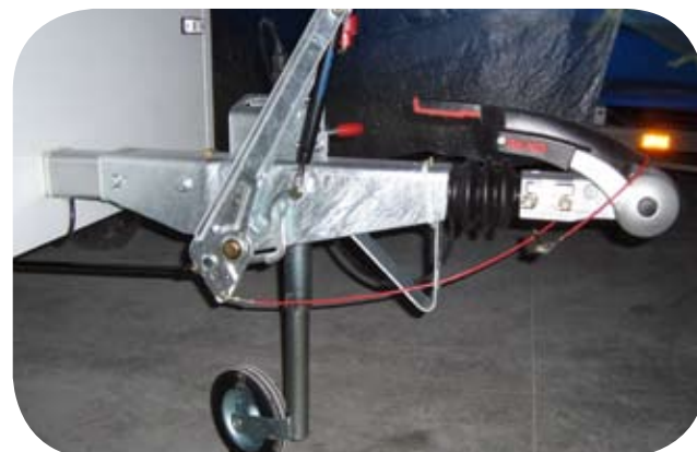
Rys. 6. Elementy układu hamulcowego: hamulec bezwładnościowy i hamulec ręczny postojowy
