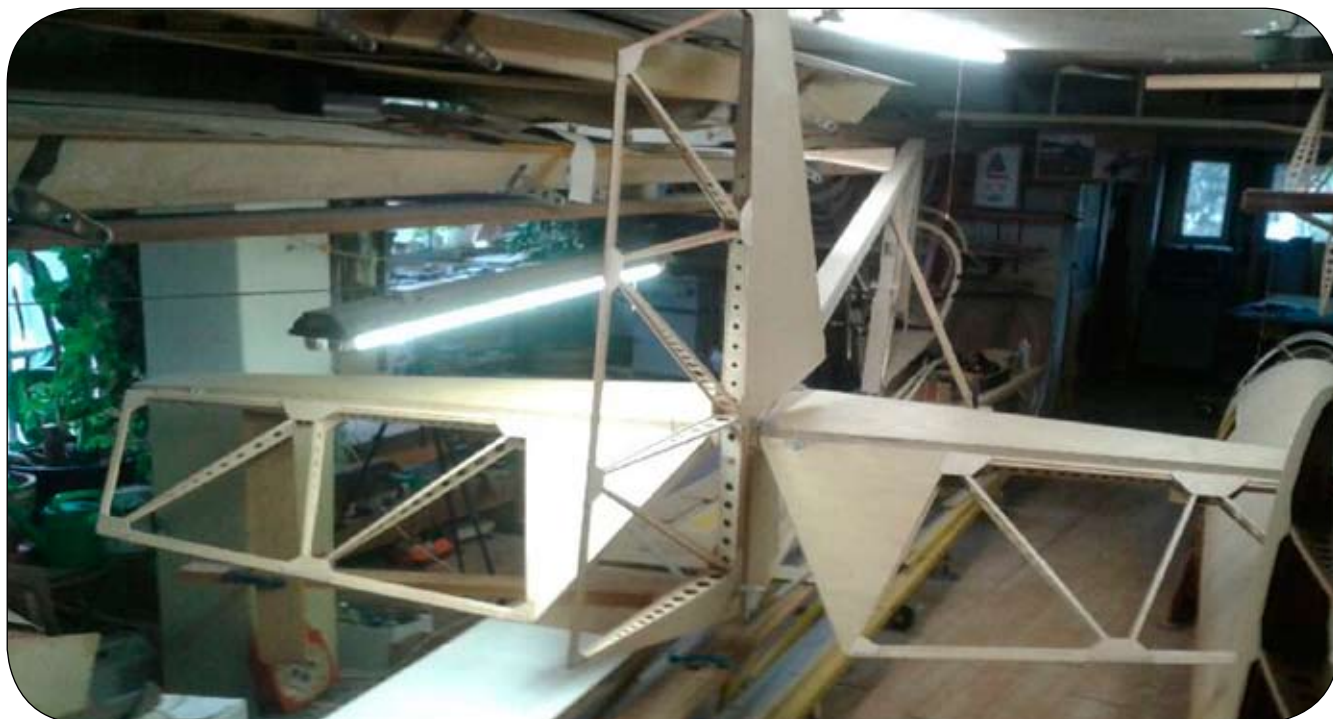
Rys. 4. Tył kadłuba z usterzeniami. Fot. Jerzy Gruchalski
