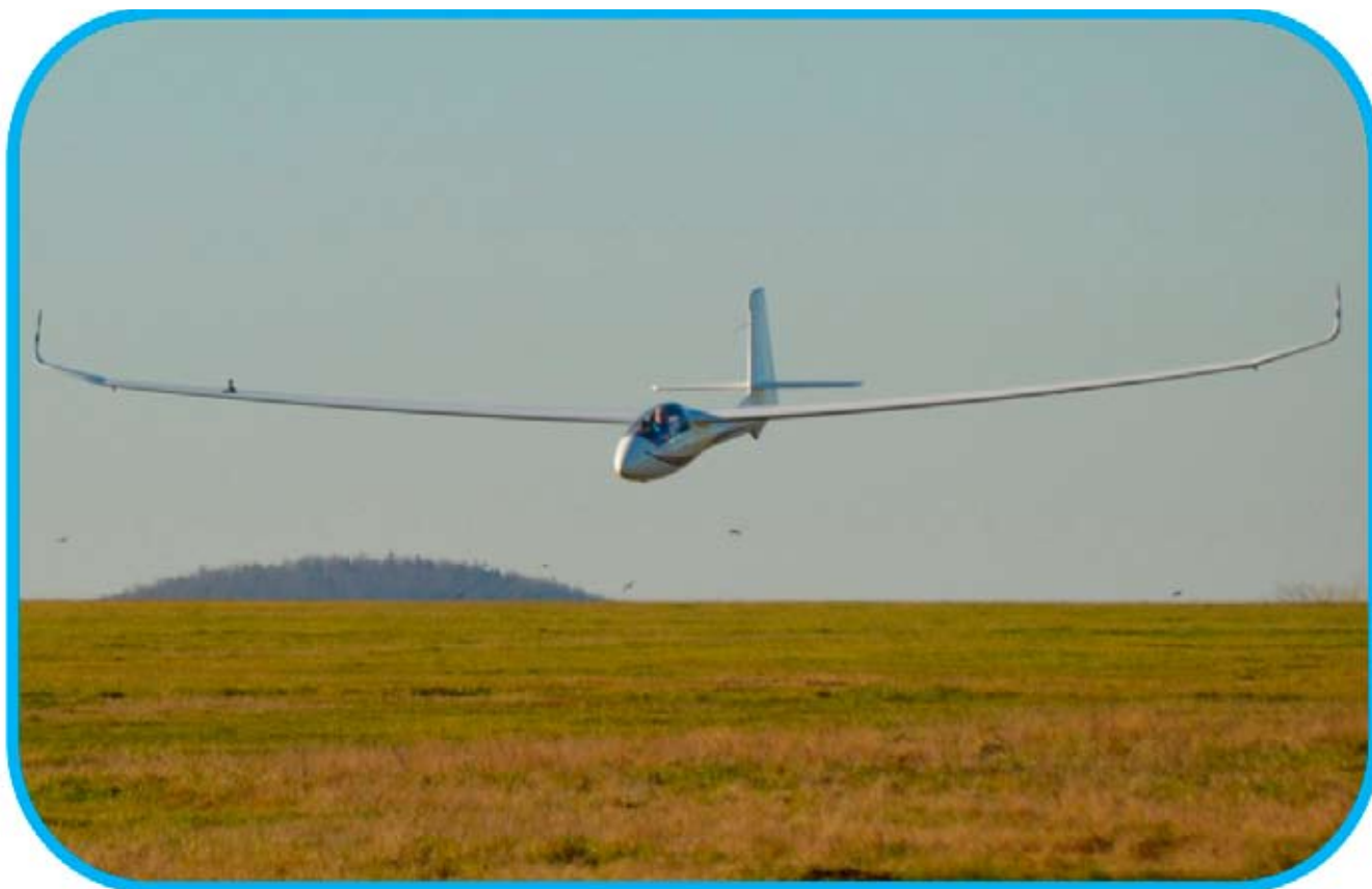
Rys. 8. Zmodyfikowana do 17 m rozpiętości wersja szybowca SZD-59 „Acro”
