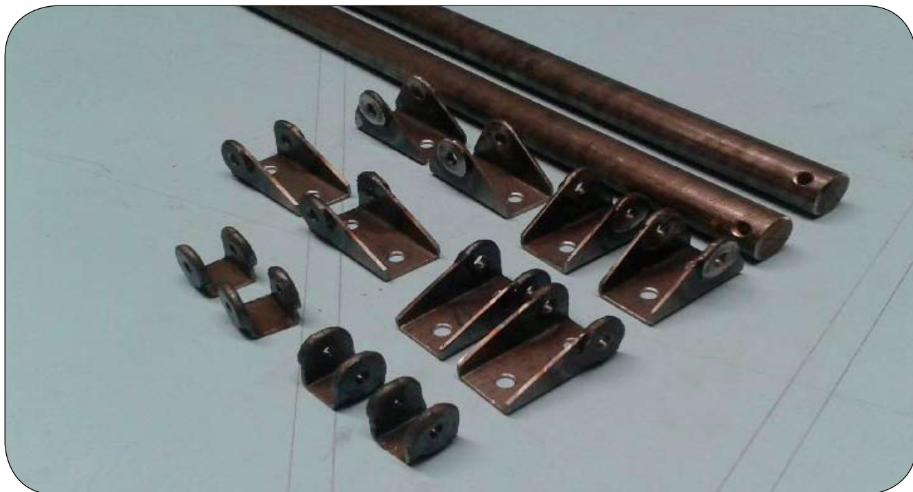
Rys. 8. Okucia usterzenia poziomego przed malowaniem. Fot. Jerzy Gruchalski
