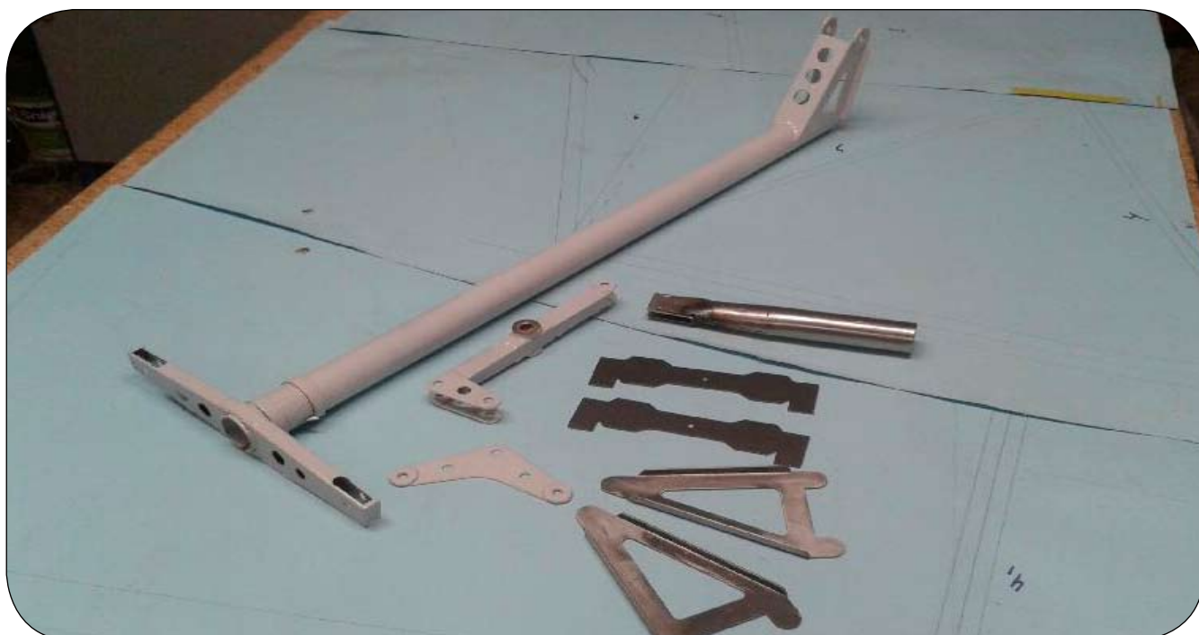
Rys. 5. Części sterownicy. Fot. Jerzy Gruchalski
