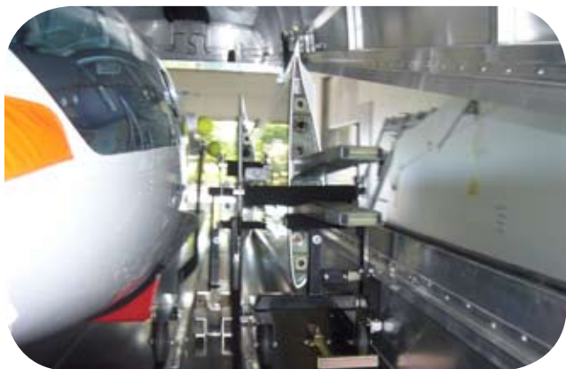
Rys. 7. Wnętrze przyczepy z elementami wyposażenia umożliwiającymi prawidłowe ułożenie i bezpieczny transport szybowca
