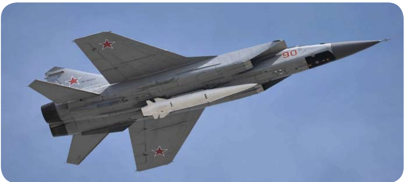
Samolot myśliwski MiG-31K z hipersonicznym pociskiem powietrze-ziemia Ch-47M2 Kinżdał (kod NATO: Killjoy ) [38] (Wikipedia)
