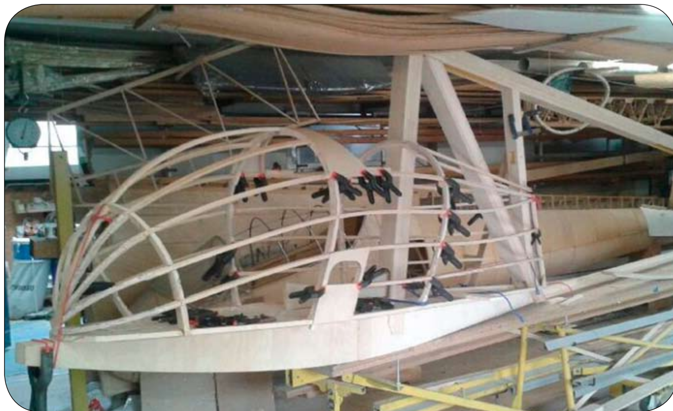
Rys. 3. Kompletny kadłub szybowca Czajka II. Kabinka była kryta płótnem. Fot. Jerzy Gruchalski
