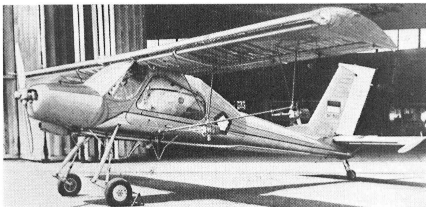
Opracowana w Indonezji odmiana rolnicza samolotu PZL-104 Gelatik z rozpryskiwaczami (atomizerami)
