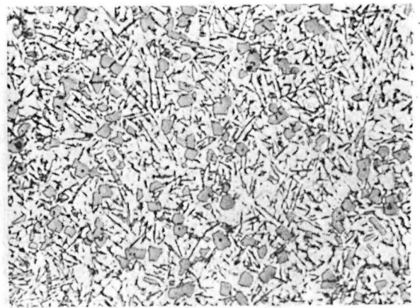
16. Mikrostruktura siluminu nadeutektycznego AK20: a — bez modyfikacji, pow. 130X, b — po modyfikacji fosforem, pow. 130X
