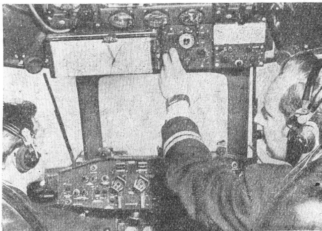
Rys. 38. Automat Decca rysujący przebytą drogę, tablica sterująca i trzy deccametry w kabine samolotu Viscount
