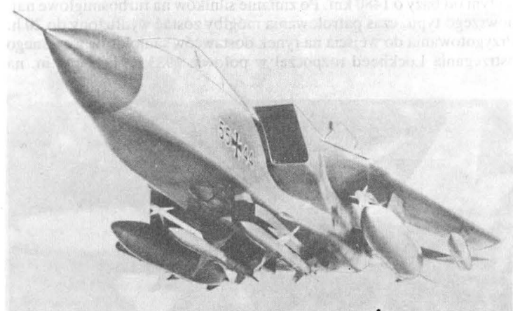
Rys. 4. Samolot Panavia Tornado ECR z typowym zestawem podwieszeń zewnętrznych
