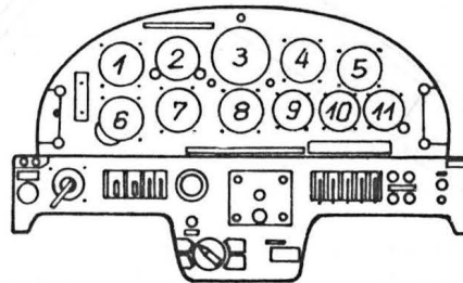
Rys. Tablica przyrządów Z-50M: 1 – prędkościomierz, 2 – zegar, 3 – busola, 4 – obrotomierz, 5 – trójwskazówkowy kontroler silnika, 6 – wysokościomierz, 7 – wariometr, 8 – zakrętomierz, 9 – wolt-ampieromierz, 10 – termometr głowic cylindrów, 11 – przeciążeniomierz
