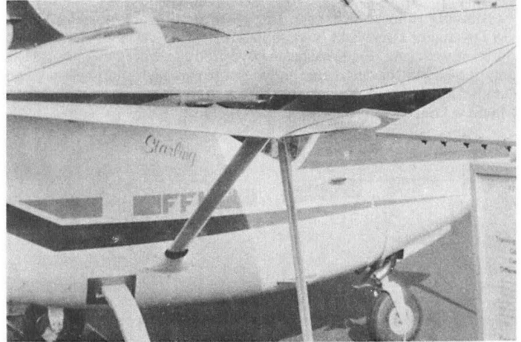
Rys. 2. Junkersowska kłapa Starlinga. Fot. A. Glass
