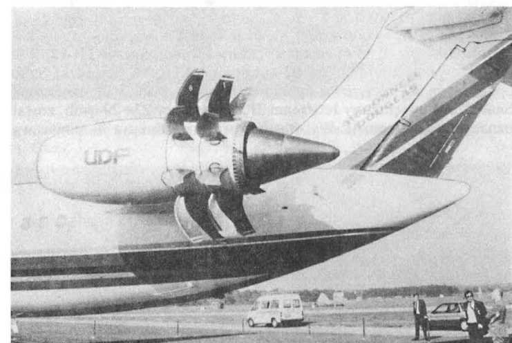
Rys. 21. MD-80 z napędem śmigłowentylatorowym. Fot. R. Małachowski
