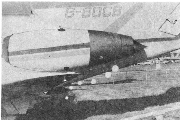
Rys. 10. Kulkowe odgromniki na prętach za krawędzią splywu na BAe 125. Fot. A. Glass
