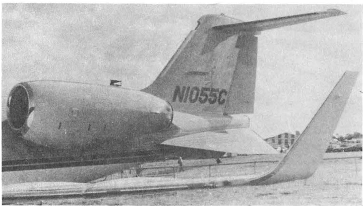
Rys. 9. Końcówka płata: stateczniki podkadłubowe samolotu Learjet 550. Fot. A. Glass
