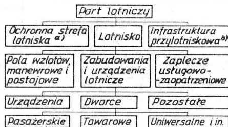
Rys. 7. Zasadnicze elementy techniki klasyfikacji portu lotniczego: a) dotyczy głównie wysokościowego ograniczenia zabudowy wokół lotniska oraz innych ograniczeń wynikających ze szkodliwego poziomu natężenia hałasu lotniczego, b) obejmuje drogi i środki transportowe łączące port lotniczy z centrum miasta i pobliskimi aglomeracjami, parkingi samochodowe, hotele, składy spedytorów itp.
