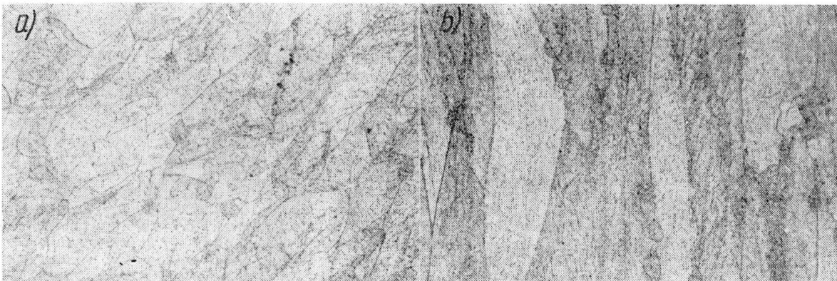
Rys. 3. Mikrostruktura stopu WT22: a) przekrój poprzeczny, b) przekrój podłużny. Pow. 100X
