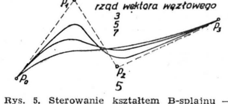
Rys. 5. Sterowanie kształtem B-splajnu — zmiana rzędu wektora węzłowego
