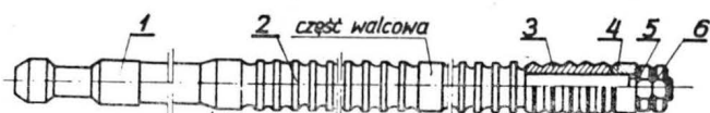
Rys. 1. Przeciągacz składany do otworów okrągłych z ostrzami ugniatającymi z węglików spiekanych: 1 — chwyt, 2 — część zdzierająca i wykańczająca, 3 — blok ugniatający, 4 — prowadzenie tylne, 5 — nakrętka, 6 — przeciwnakrętka
