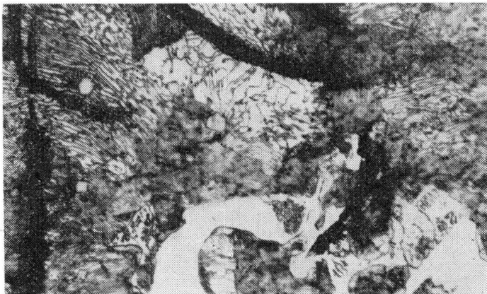
Rys. 7. Mikrostruktura po wytrawieniu zużytego pierścienia uszczelniającego (bez warstwy chromowej)
