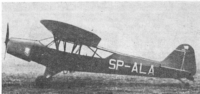
Rys. 1. Piper Cub L-4J SP-ALA wyposażony w 1949 r. w silnik rzędowy Walter Mikron III
