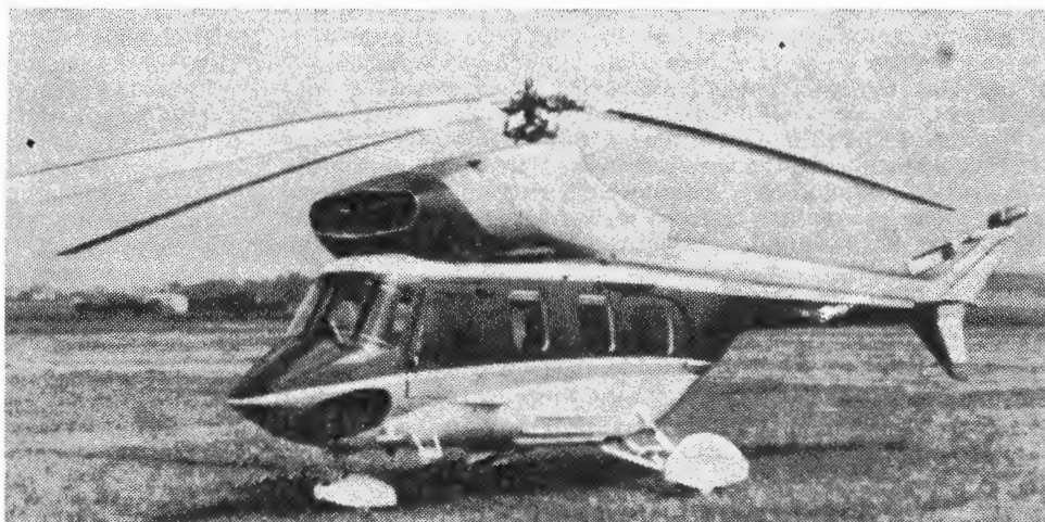
Rys. 1. Makleta śmigłowca PZL-Taurus/Mock-up of PZL-Taurus helicopter
