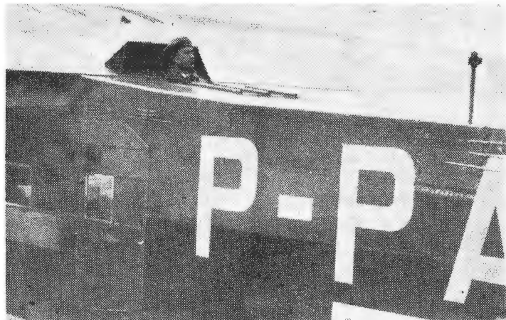
Rys. 11. Po odsunięciu pokrywy i podniesieniu osłony nawigator mógł wykonywać namiary sekstanssem i pomiary znoszenia. Na kadłubie widoczny maszt wiatraczka napędu busoli indukcyjnej
