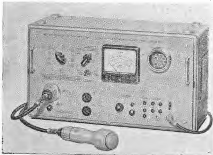
Rys. 20. Precyzyjny miernik natężenia dźwięku, typu EZGN firmy Rohde & Schwarz
