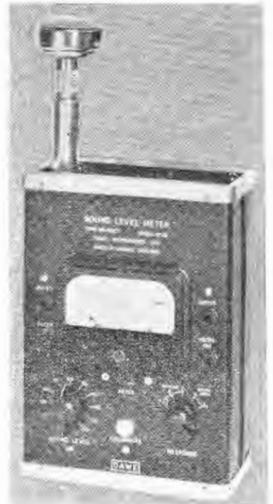
Rys. 21. Miernik natężenia dźwięku, typu 1400 E, angielskiej firmy Dawe Instruments Limited
