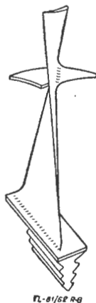
Rys. 8. Łopatki turbiny z półką zewnętrzną
