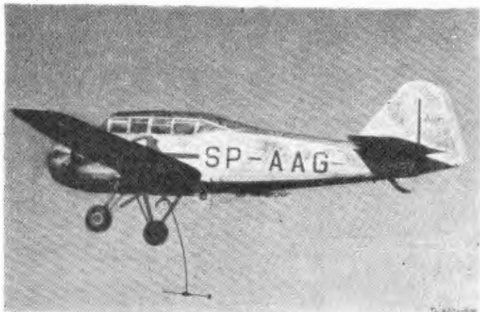
Rys. 24. Sonda statyczna — w czasie wypuszczania z samolotu, pełna długość kabla podwieszającego wynosi ok. 20 m
