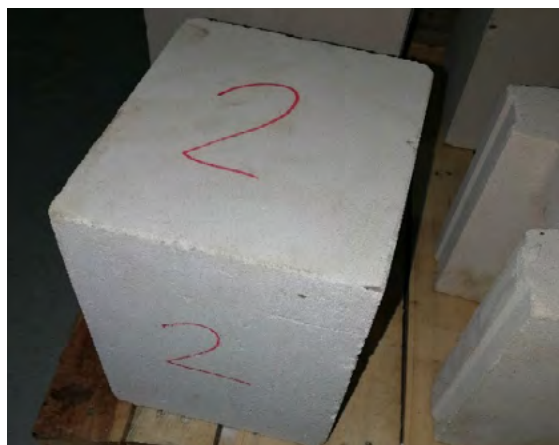
Ryc. 2. Błoczek silikatowy Silka E-A, zawierający kruszywo bazaltowe
