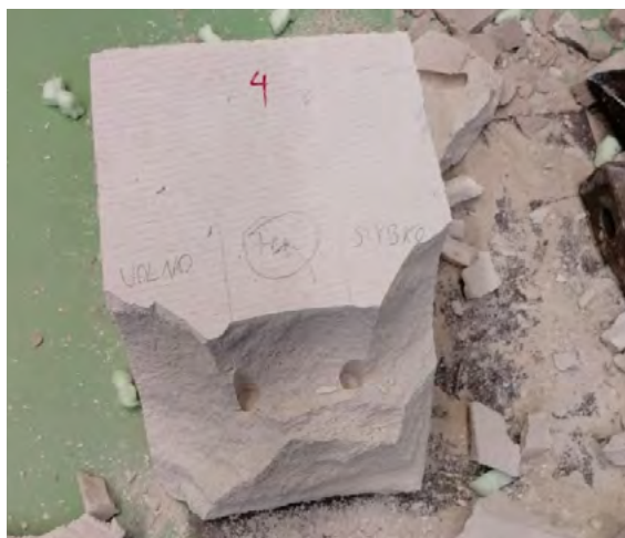
Ryc. 9. Bloczek betonu komórkowego po odkuciu próbek
