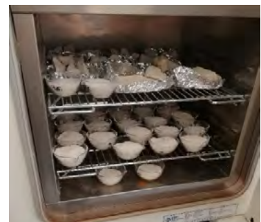
Ryc. 15. Próbkki w suszarce laboratoryjnej EcoCell 55
