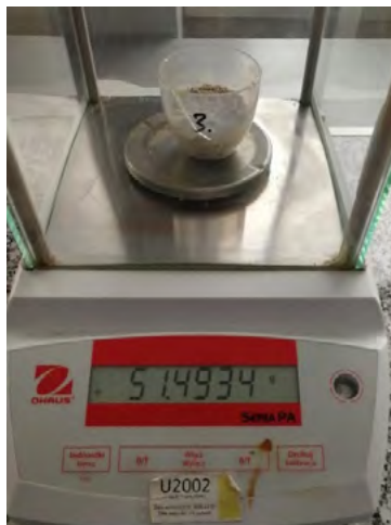
Ryc. 14. Ważenie zwierziny na wadze laboratoryjnej Waga Ohaus Pioneer PA413/1
