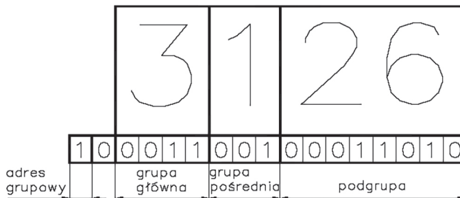
Rys. 8.4. Adres grupowy w systemie KNX/EIB
