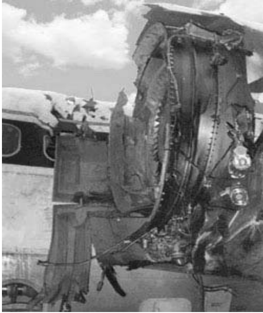
Fig. 1. Jet engine fan section failure
