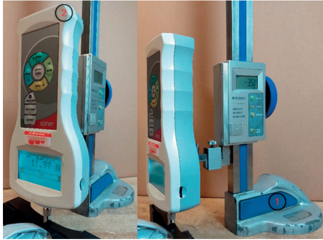
Rysunek 4. Stanowisko do badania ugięcia trzypunktowego; wysokościomierz (1), miernik siły (2)
