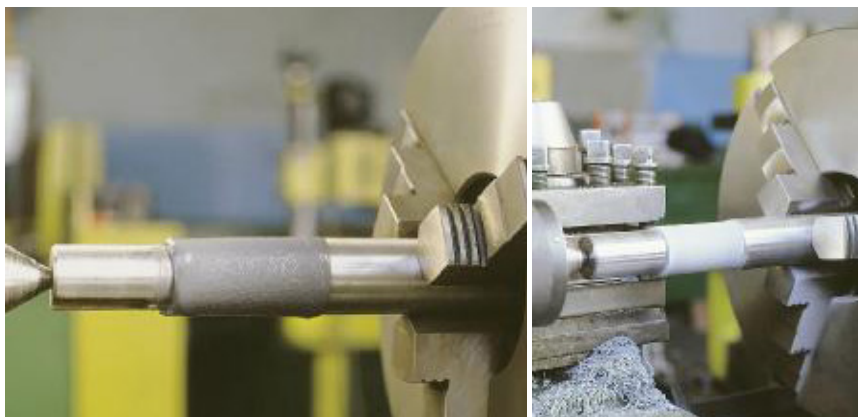
Rys. 7.7. Zregenerowany czop wału oraz jego obróbka skrawaniem na żądany wymiar
