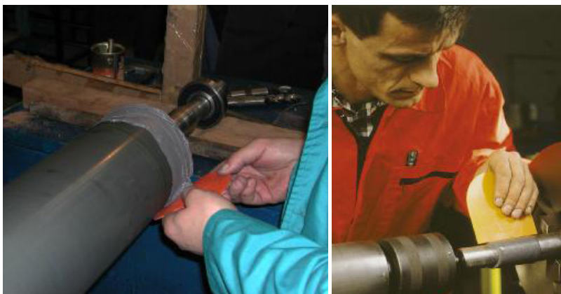
Rys. 7.6. Aplikacja masy regeneracyjnej na czop wału
