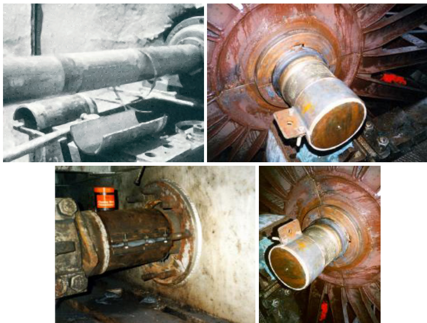
Rys. 7.9. Naprawa wału metodą odwzorowania powierzchni
