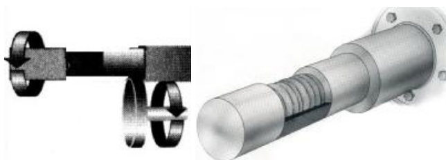
Rys. 7.8. Przygotowanie czopu wału do regeneracji
