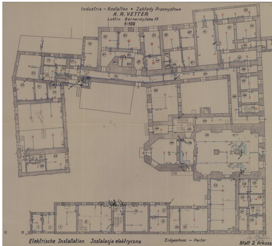
Ryc. 104. Projekt instalacji elektrycznej – rzut parteru, 1942 r.; APL, Z.P.K.R. „Vetter” w Lublinie, sygn. 105, s. 22
