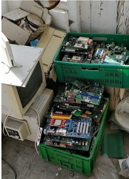
Rysunek 2. Płyty główne pochodzące z demontażu
