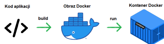
Rysunek 2: Budowanie obrazu Docker oraz uruchomienie kontenera Docker [13].
