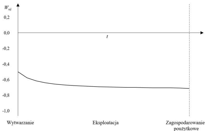
Rys. 4.82. Zmiana wartości wskaźnika następstw środowiskowych dla emisji gazów cieplarnianych w cyklu istnienia, gdzie pojazd konwencjonalny ( P_K ) stanowi ICEV zasilany benzyną, z segmentu A i B, który ma zostać zarejestrowany w roku 2050 i będzie spełniał główne założenia Porozumienia paryskiego, a pojazd nowy ( P_N ) – ICEV zasilany benzyną, z segmentu SUV, zarejestrowany w roku 2020
