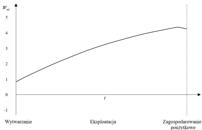
Rys. 4.89. Zmiana wartości wskaźnika następstw środowiskowych dla emisji gazów cieplarnianych w cyklu istnienia, gdzie pojazd konwencjonalny ( P_K ) stanowi PHEV zasilany benzyną, z segmentu SUV, zarejestrowany w roku 2020, a pojazd nowy ( P_N ) – BEV, z segmentów A i B, który ma zostać zarejestrowany w roku 2050 i będzie spełniał główne założenia Porozumienia paryskiego
