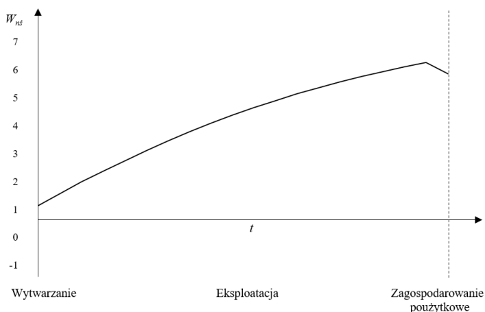
Rys. 4.93. Zmiana wartości wskaźnika następstw środowiskowych dla emisji gazów cieplarnianych w cyklu istnienia, gdzie pojazd konwencjonalny ( P_K ) stanowi FCEV, z segmentu SUV, zarejestrowany w roku 2020, a pojazd nowy ( P_N ) – BEV, z segmentu A i B, który ma zostać zarejestrowany w roku 2050 i będzie spełniał główne założenia Porozumienia paryskiego
