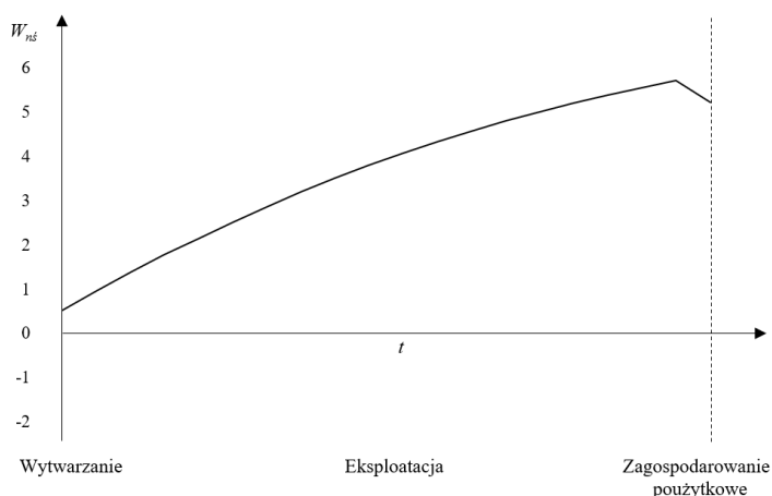
Rys. 4.87. Zmiana wartości wskaźnika następstw środowiskowych dla emisji gazów cieplarnianych w cyklu istnienia, gdzie pojazd konwencjonalny ( P_K ) stanowi ICEV zasilany CNG, z segmentu SUV, zarejestrowany w roku 2020, a pojazd nowy ( P_N ) – BEV, z segmentu A i B, który ma zostać zarejestrowany w roku 2050 i będzie spełniał główne założenia Porozumienia paryskiego
