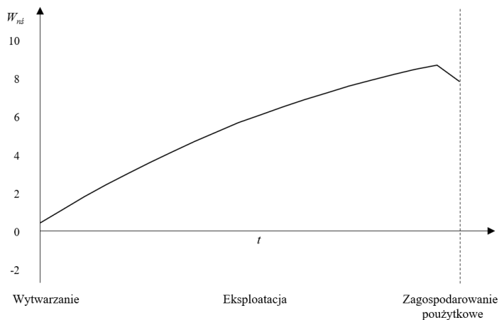
Rys. 4.83. Zmiana wartości wskaźnika następstw środowiskowych dla emisji gazów cieplarnianych w cyklu istnienia, gdzie pojazd konwencjonalny ( P_K ) stanowi ICEV zasilany benzyną, z segmentu SUV, zarejestrowany w roku 2020, a pojazd nowy ( P_N ) – BEV, z segmentów A i B, który ma zostać zarejestrowany w roku 2050 i będzie spełniał główne założenia Porozumienia paryskiego
