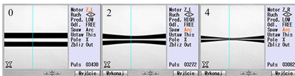
Rys. 10. Wpływ ilości powtórzeń łuku elektrycznego na wielkość przewężenia światłowodu
