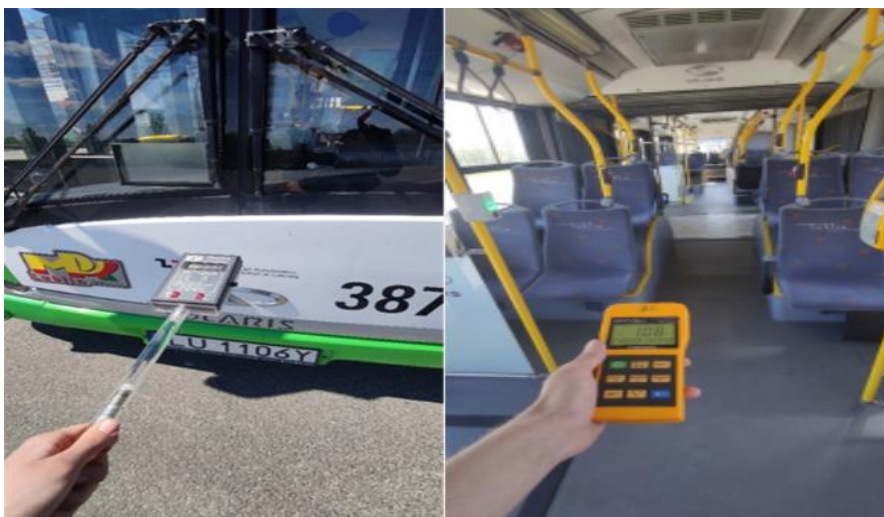
Rys. 9. Przykładowe pomiary pola elektrycznego i magnetycznego
