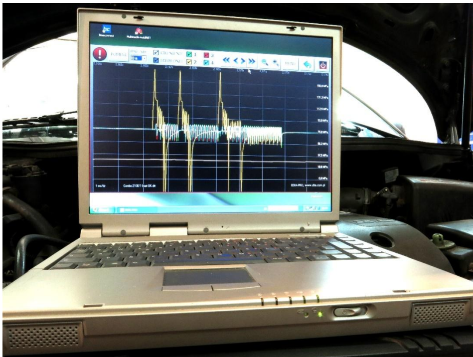
Rys. 2. Analiza parametrów bieżących systemu CR oscyloskopem EDIA-PRO
