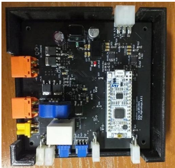
Rys. 7. Gotowy sterownik przepływu pojazdu
