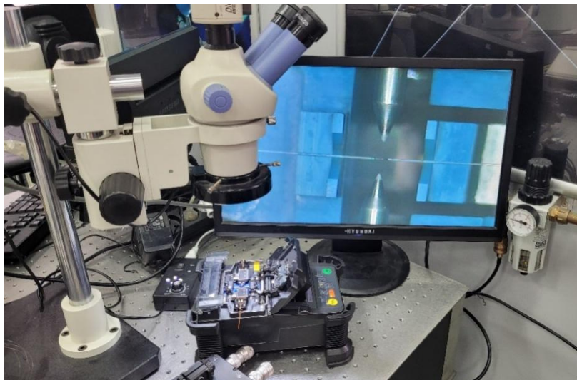
Rys. 5. Stanowisko z mikroskopem optycznym do obserwacji przewężen
