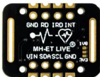
Rys. 3. Moduł MAX30102 wykorzystany w projekcie [8]
