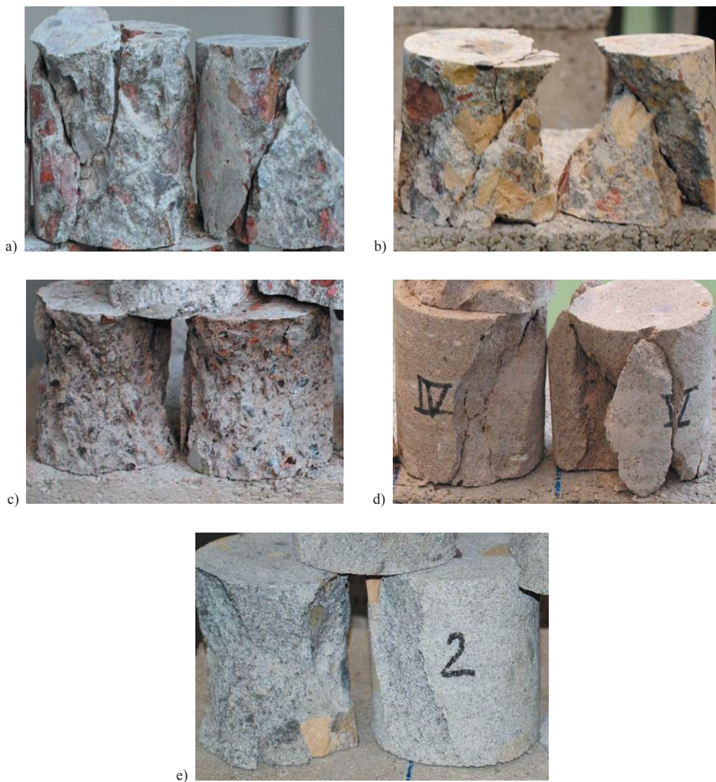
Rysunek 65. Faktury złomów próbek betonu pobranego z: a) ustroju nośnego, b) przyczółka, c) z elementów prefabrykowanych balustrady, d) ze skrzydeł – beton piaskowy, e) zaprawy cementowej
