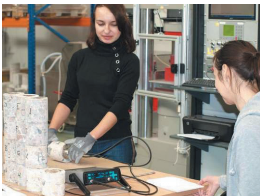
Rysunek 64. a) badania betonoskopem, b) stanowisko ściskania próbek
