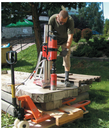
Rysunek 63. a) pobieranie rdzeni betonowych z bloków betonu z mostu, b) pobrane rdzenie
