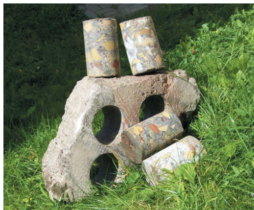
Rysunek 63. a) pobieranie rdzeni betonowych z bloków betonu z mostu, b) pobrane rdzenie
