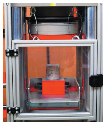
Rysunek 64. a) badania betonoskopem, b) stanowisko ściskania próbek
