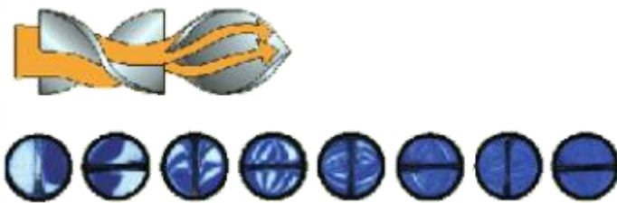
Rys. 3.33. Schemat działania mieszadła śrubowego [5, 67]
