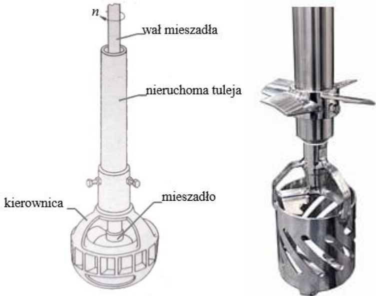
Rys. 3.6. Mieszadło turbinowe z kierownicą [opracowanie własne, 12]
