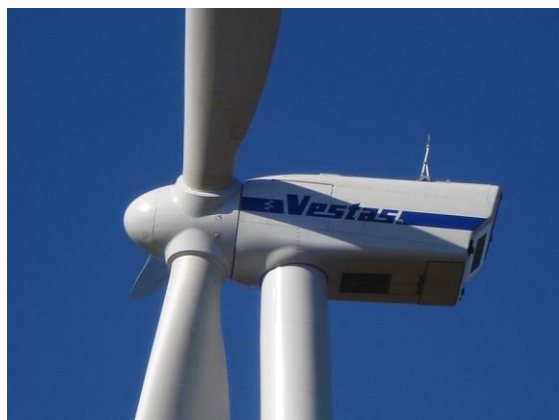
Rys. 3.2. Zdjęcie gondoli elektrowni wiatrowej z generatorem asynchronicznym typu DFIG Vestas V90 3 MW [25]
