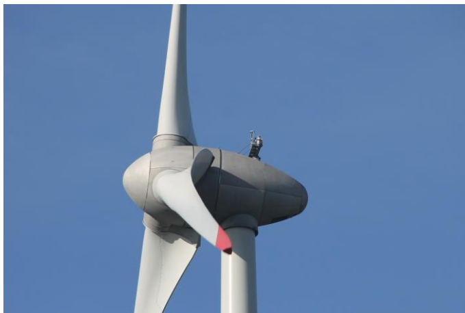
Rys. 3.4. Zdjęcie gondoli elektrowni wiatrowej z generatorem synchronicznym typu FC Enercon E82 2 MW [25]
