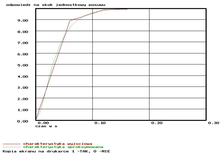
Rys. 3.6. Charakterystyka czasowa wyjściowa (dokładna i aproksymowana) [196]
