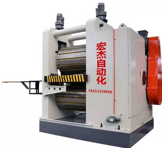
Rys. 2.32. Walcarka poprzeczno-klinowa Zibo Hong Jie Automation Equipment Co. Ltd [90]
