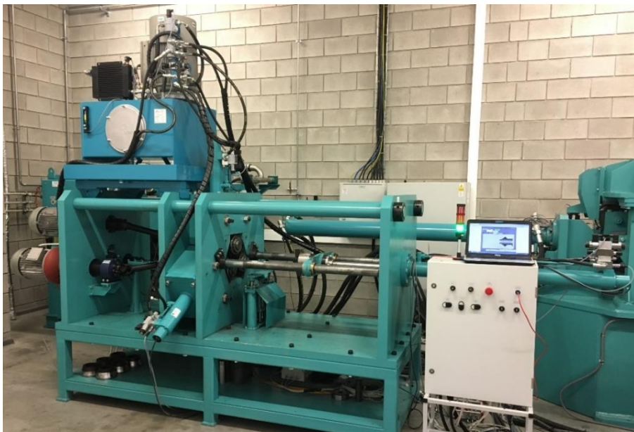
Rys. 5.52. Zmodernizowana laboratoryjna walcarka skośna z trzema rollkami kształtującymi
