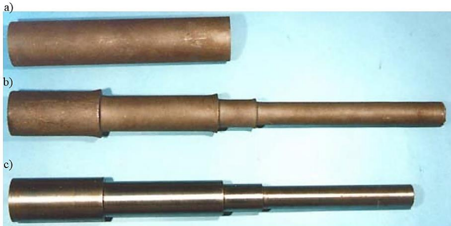
Rys. 2.15. Odwulka stopniowanego wału: a) wsad, b) odwalcowany wyrób, c) wyrób po obróbce skrawaniem [9]
