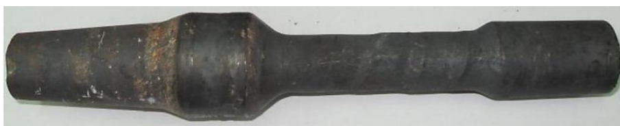
Rys. 2.13. Przedkuwka dźwigni odwalcowana w walcierce dwuwalcowej [75]
