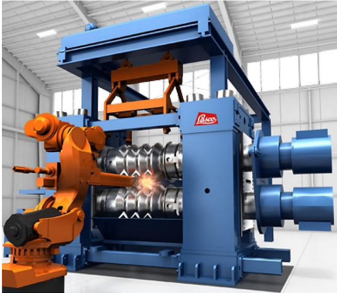
Rys. 2.30. Walcarka ramowo-konsolowa Lasco RCW wraz z manipulatorem przemysłowym [19]
