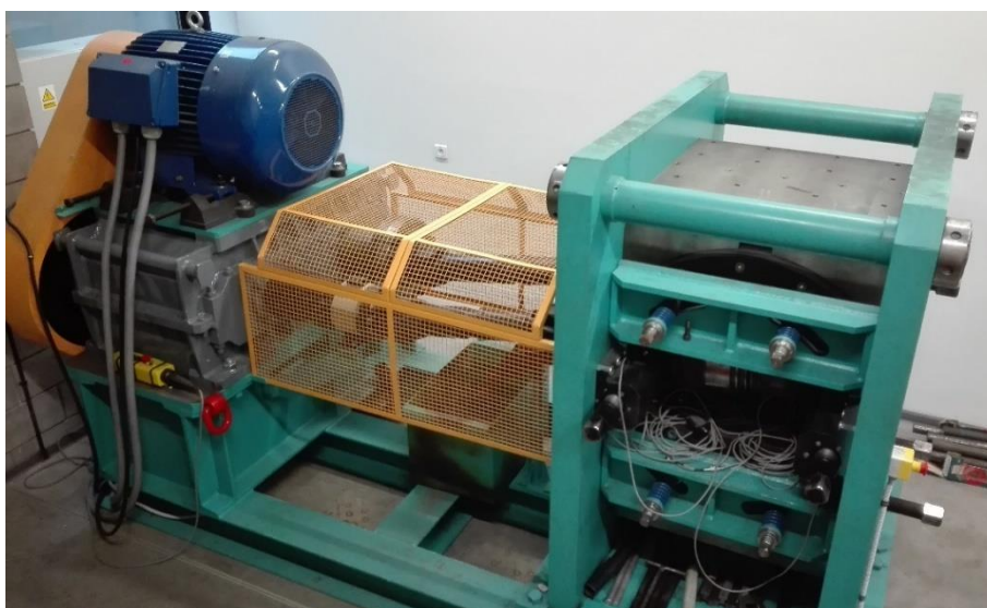
Rys. 2.40. Walcarka skośna skonstruowana w Politechnice Lubelskiej
