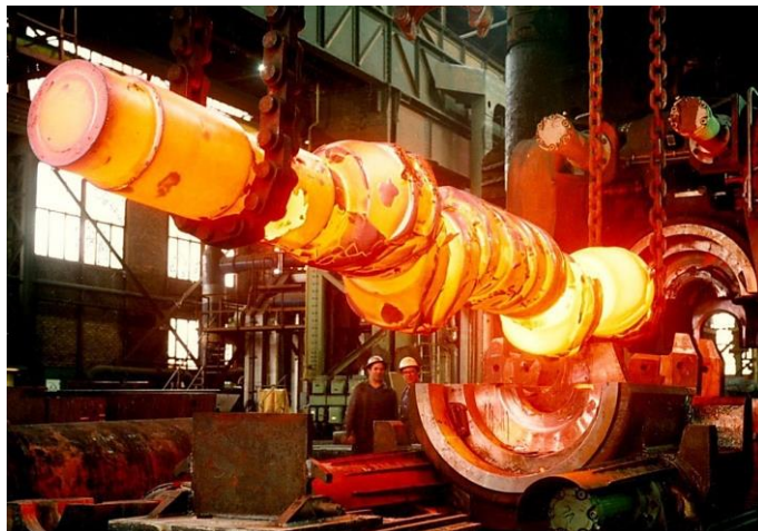
Rys. 2.4. Odkuwka wału korbowego otrzymana metodą TR [92]
