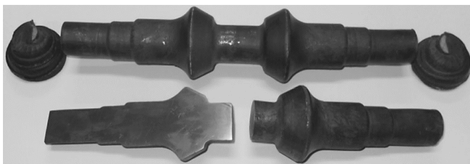
Rys. 2.12. Odkuwka wałka stopniowanego odwalcowanego w walcierce płaskoklinowej [46]
