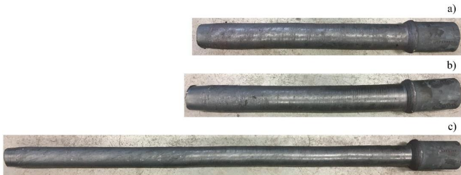
Rys. 5.59. Zdeformowane próbki badawcze poprzez wyboczenie: a) \alpha = 15^\circ , \theta = 7,5^\circ , V_u = 20 mm/s, \delta = 1,3 , b) \alpha = 20^\circ , \theta = 7,5^\circ , V_u = 20 mm/s, \delta = 1,3 , c) \alpha = 25^\circ , \theta = 7,5^\circ , V_u = 20 mm/s, \delta = 1,53
