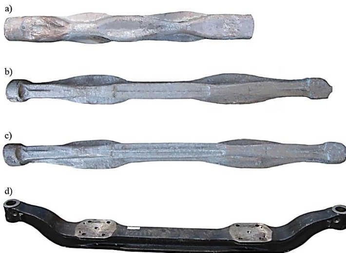
Rys. 2.10. Kształtowanie belki osi przedniej samochodowej w procesie walcowania wzdłużnego: a) po pierwszym przepuszczeniu, b) po drugim przepuszczeniu, c) po trzecim przepuszczeniu, d) gotowy wyrób [102]
