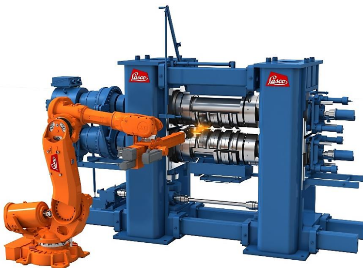
Rys. 2.28. Walcarka ramowa Lasco RCW wraz z manipulatorem przemysłowym [93]
