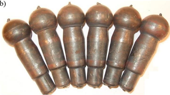
Rys. 2.19. Odkuwki uzyskane w procesie walcowania śrubowo-klinowego: a) kula \varnothing 33mm, b) sworznie kuliste [3, 43]
