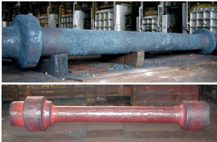
Rys. 2.2. Odkuwki wałów pośrednich otrzymanych metodą kucia swobodnego [69]
