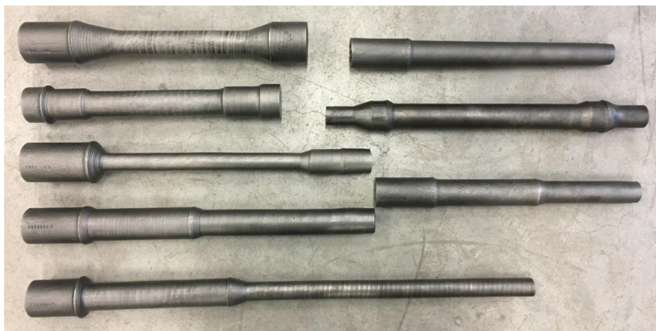
Rys. 5.58. Przykładowe wyroby otrzymane metodą walcowania skośnego za pomocą trzech rolek stożkowych
