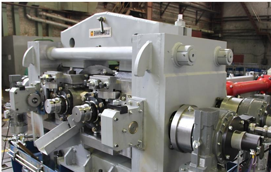
Rys. 2.39. Kuźnicza walcarka skośna Vniimetmash SHPS (ros. IIIIC ) [95]
