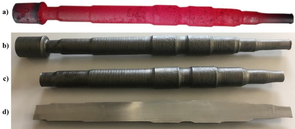
Rys. 5.53. Odkuwka wału do lekkiego samochodu transportowego: a) bezpośrednio po procesie walcowania, b) po śrutowaniu, c) po odcięciu nadatków technologicznych, d) przekrój osiowy
