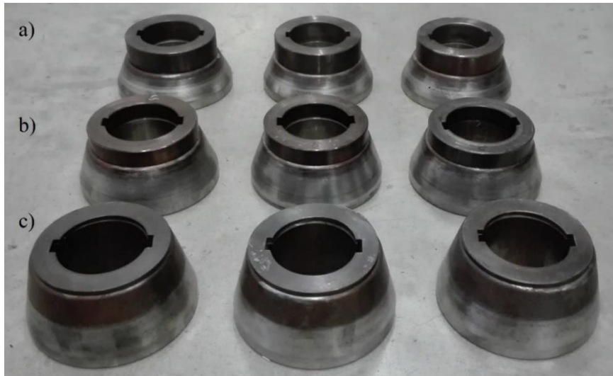
Rys. 4.7. Zestaw rolek stożkowych wraz z pierścieniami dystansowymi: a) \alpha = 25^\circ , b) \alpha = 20^\circ , c) \alpha = 15^\circ
