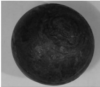
Rys. 2.19. Odkuwki uzyskane w procesie walcowania śrubowo-klinowego: a) kula \varnothing 33mm, b) sworznie kuliste [3, 43]
