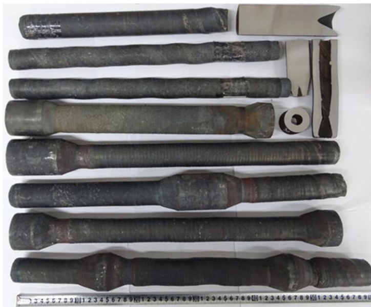
Rys. 2.21. Wyroby uzyskane metodą walcowania skośnego za pomocą rolek stożkowych [21]
