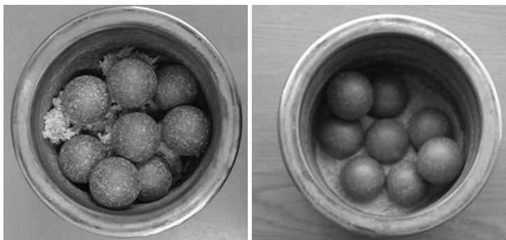
Rys. 12.2. Fragmenty próbki umieszczonej w naczyniu z kulkami mielącymi (po lewej) oraz zmielona próbka kompozytu (po prawej) [P. Brzyski]
