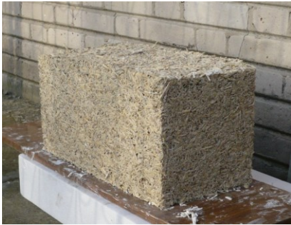
Rys. 5.23. Pełny bloczek wapienno-konopny [P. Brzyski]
