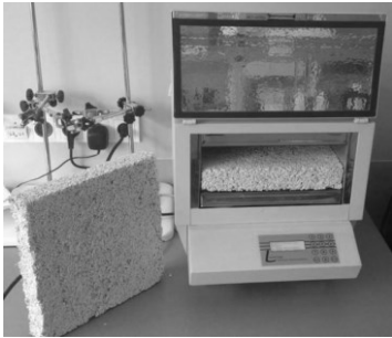
Rys. 12.4. Próbkę kompozytu wapienno-konopnego umieszczona w aparacie płytowym Fox314 [P. Brzyski]
