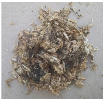
Rys. 5.14. Paździerze zniszczone w wyniku działania korozji biologicznej [P. Brzyski]
