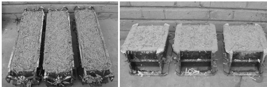
Rys. 10.1. Przykładowe próbki mieszanki wapienno-konopnej (Seria 1) zaformowane w formy o wymiarach: 100×100×500 mm (po lewej), 150×150×150 mm (po prawej) [P. Brzyski]
