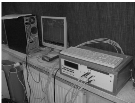
Rys. 12.17. Zestaw pomiarowy TDR: komputer oraz miernik [P. Brzyski]
