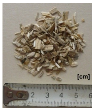
Rys. 5.17. Paździerze konopne o długości mniejszej niż 5 mm [P. Brzyski]
