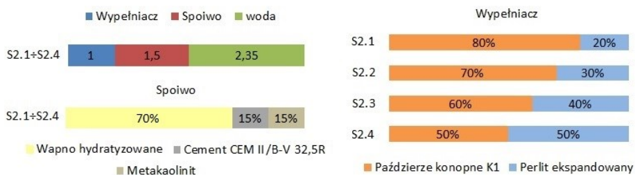
Rys. 8.3. Proporcje wykorzystane w Serii 2 : proporcje wagowe wypełniacz: spoiwo: woda oraz proporcje w % wagowo w składzie spoiwa (po lewej); proporcje w % w składzie wypełniacza (po prawej)
