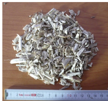
Rys. 5.8. Paździerz konopne do zastosowania w budownictwie [P. Brzyski]
