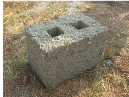
Rys. 5.24. Drażony bloczek wapienno- -konopny [P. Brzyski]
