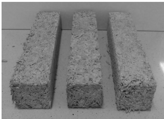
Rys. 12.44. Próbkki kompozytu wapienno-konopnego wykorzystane do badania wytrzymałości na zginanie (przykładowe próbki z Serii 1 ) [P. Brzyski]
