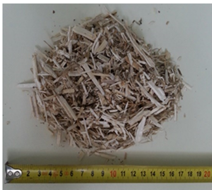
Rys. 7.1. Paździerz konopny K1 odmiany Białobrzeskie wykorzystane w badaniach (producent IWNIRZ) [P. Brzyski]
