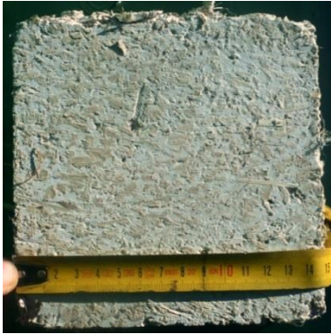
Rys. 5.1. Przekrój przez próbkę kompozytu wapienno-konopnego [P. Brzyski]
