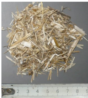
Rys.7.4. Paździerz lniane wykorzystane w badaniach [P. Brzyski]
