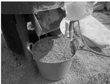
Rys. 9.2. Gotowa mieszanka wapienno-konopna [P. Brzyski]
