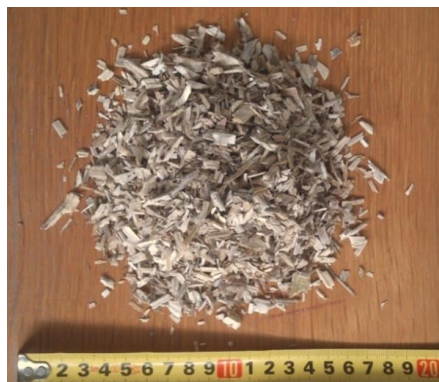
Rys. 7.2. Paździerz konopny K2 odmiany Białobrzeskie wykorzystane w badaniach (producent Podlaskie Konopie) [P. Brzyski]
