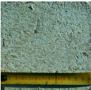
Rys. 12.32. Przekrój przez próbkę wapienno-konopną [P. Brzyski]
