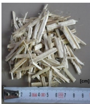
Rys. 5.16. Paździerze konopne o długościach powyżej 30 mm [P. Brzyski]
