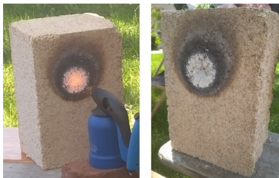
Rys. 5.33. Test reakcji na ogień bloczka z kompozytu wapienno-konopnego [P. Brzyski]
