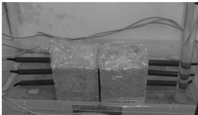
Rys. 12.19. Stanowisko badawcze testu podciągania kapilarnego metodą TDR [P. Brzyski]
