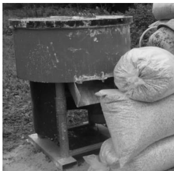
Rys. 9.1. Mieszalnik do mieszania składników kompozytu wapienno-konopnego [P. Brzyski]
