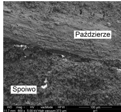
Rys. 12.35. Strefa styku pomiędzy spoiwem a wypełniaczem ( \times 800 ) [P. Brzyski]
