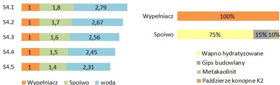
Rys. 8.7. Proporcje wykorzystane w Serii 4 : proporcje wagowe wypełniacz: spoiwo: woda oraz proporcje w % wagowo w składzie spoiwa (po lewej); proporcje w % w składzie wypełniacza (po prawej)
