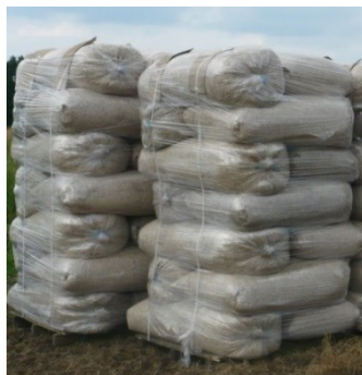
Rys. 5.15. Paździerze konopne na placu budowy, zapakowane w workach 25 kg [P. Brzyski]
