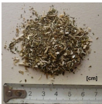
Rys. 5.12. Paździerz zanieczyszczony pyłem pochodzącym z rośliny oraz kurzem [P. Brzyski]
