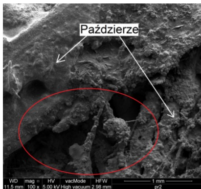
Rys. 12.40. Puste przestrzenie powstałe pomiędzy losowo ułożonymi paździerzami konopnymi, oznaczone kolorem czerwonym ( \times 100 ) [P. Brzyski]
