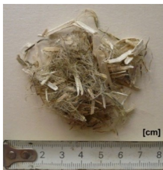
Rys. 5.13. Paździerz zanieczyszczony kłębami włókien konopnych [P. Brzyski]
