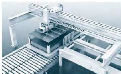
Układanie płyt metalowych: YXCL
