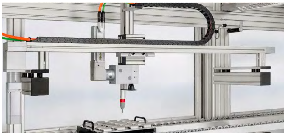
Rys. 4.1. Przykładowe rozwiązanie techniczne napędu liniowego [18]
