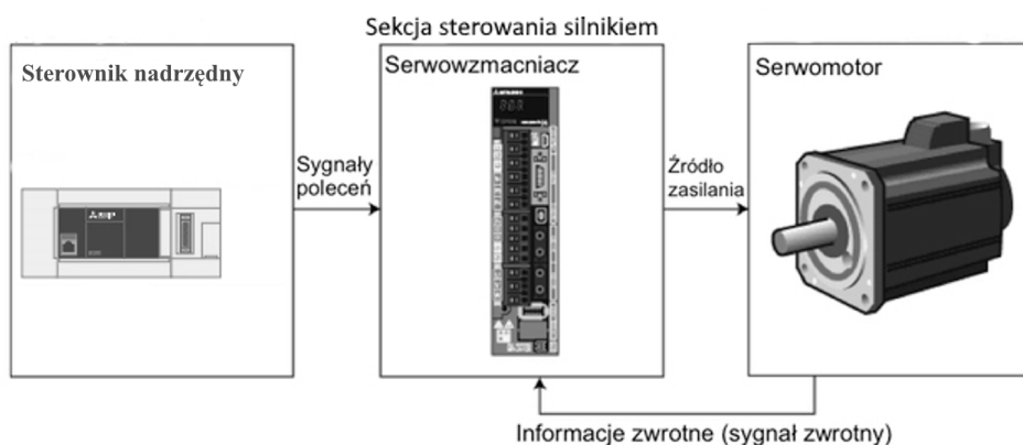
Rys. 7.1. Koncepcja sterowania serwonapędem [9]
