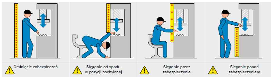
Rys. 12.10. Przykłady niewłaściwie zamontowanych ESPE [43]
