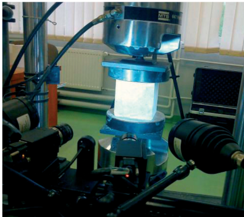
Rys. 4.2. Badnie wytrzymałości na ściskanie próbki umieszczonej w maszynie MTS 647 wyposażonej w system Aramis do pomiaru odkształceń
