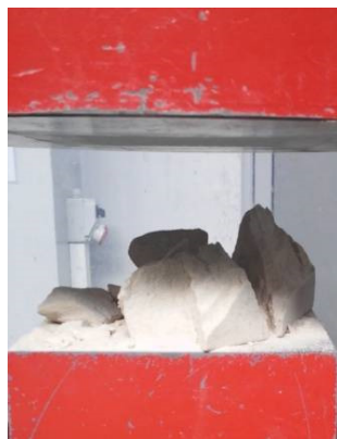
Rys. 4.14. próba ściskana próbek sześciennych z piaskowca. a) zdjęcie przed badaniem, b) zdjęcie zniszczonej próbki
