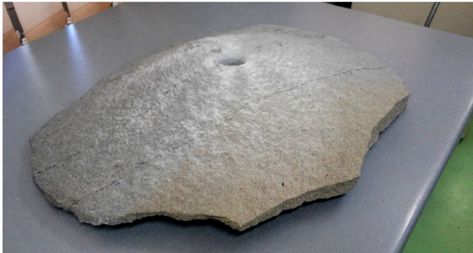
Rys. 4.12. Kształt fragmentu piaskowca wyrwanego w trakcie próby wyciągania kotwy
