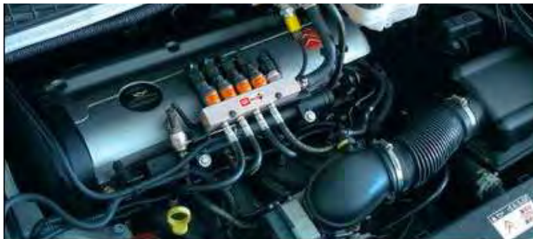
Rys. 1.15. Pośrednie mocowanie wtryskiwaczy
