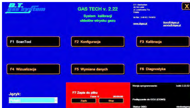
Rys. 2.12. Okno programu kalibracyjno-diagnostycznego układu wtrysku gazu firmy DT Gas System
