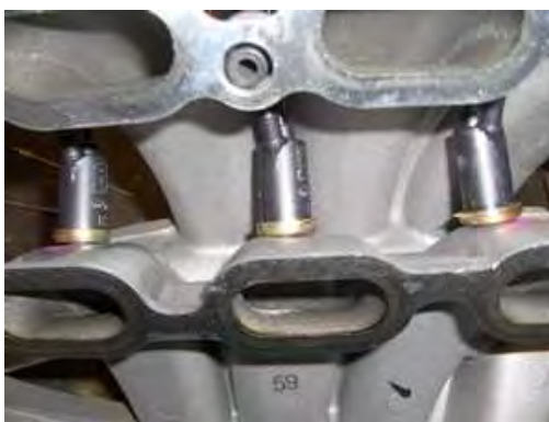
Rys. 1.14. Bezpośrednie mocowanie wtryskiwaczy na kolektorze dolotowym
