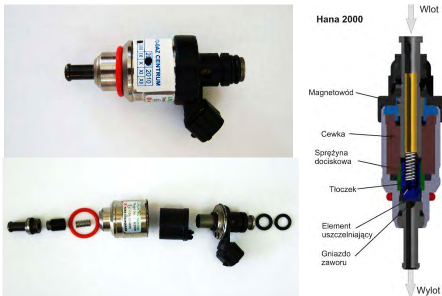
Rys. 2.3. Konstrukcja wtryskiwacza Hana H2000
