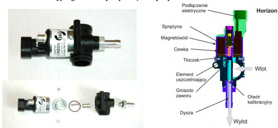
Rys. 2.4. Konstrukcja wtryskiwacza Horizon IG3
