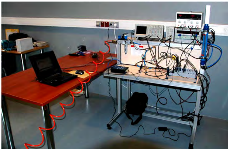
Rys. 2.24. Stanowisko pozasilnikowe badania impulsowych wtryskiwaczy gazu
