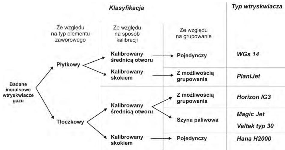
Rys. 2.2. Podział impulsowych wtryskiwaczy gazu stosowanych w czasie badań
