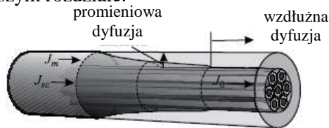
Rys. 3.8. Kompozytowy przewód nadprzewodnikowy, w którym w wyniku zaburzenia cieplnego następuje dyfuzja prądu do matrycy stabilizującej [182]
