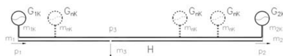
Rys. 2. Schemat diagnozowanego rurociągu z dołączonymi obiektami badawczymi (korektorami) Fig. 2. Scheme of tested pipeline with joined additional testing objects (correctors)
