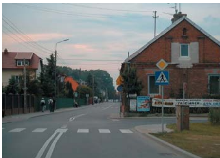
Rys.1. Przykład ograniczenia widoczności na skrzyżowaniu dróg przez budynek zasłaniający część drogi Fig. 1. Example of visibility limitation by a building obscuring part of the road intersection
