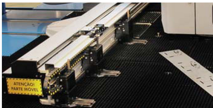
Rys. 9.3. Chwytaki przemieszczające i pozycjonujące półfabrykat na stole wykrawarki CNC napędzane śrubą toczną [45]
