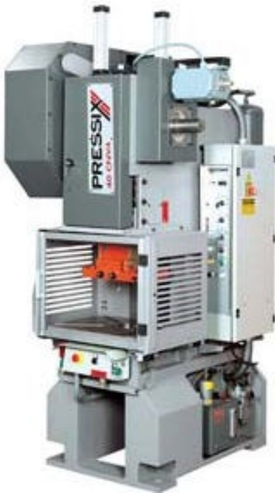
Rys. 4.8. Prasa mimośrodowa stała o nacisku 400 kN z wałem dwustronnie łożyskowanym usytuowanym równoległe do przodu prasy firmy PRESSIX [65]
