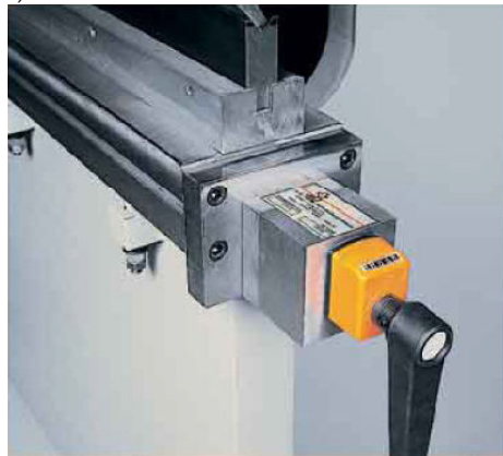
Rys. 7.41. Systemy mocowania matryc stosowane w prasach krawędziowych firmy BYSTRONIC: a) mechaniczny, b) ręczny [25]
