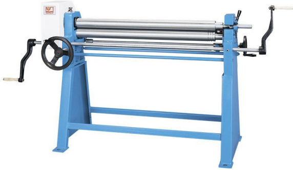
Rys. 11.13. Giętarka trójwalcowa z napędem ręcznym [74]
