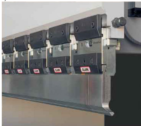
Rys. 7.40. Automatyczne systemy mocowania stempli stosowane w prasach BYSTRONIC: a) pneumatyczne, b) hydrauliczne [25]
