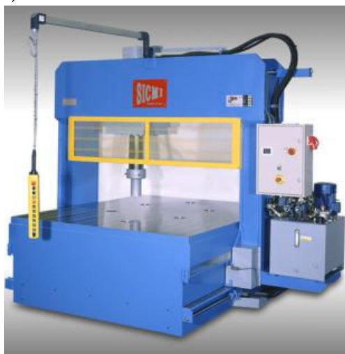
Rys. 36. Prasy hydrauliczne stosowane do: a) prostowania grubych płyt, b) tłoczenia blach karoseryjnych [71, 52]
