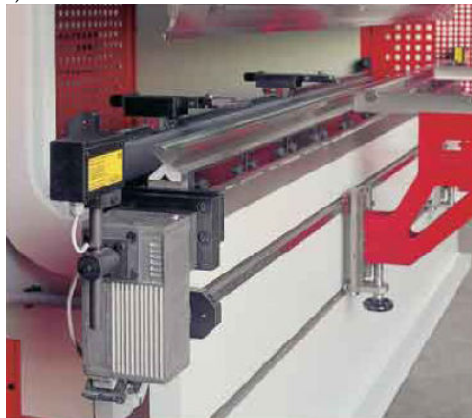
Rys. 7.41. Systemy mocowania matryc stosowane w prasach krawędziowych firmy BYSTRONIC: a) mechaniczny, b) ręczny [25]
