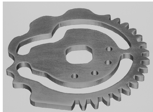
Rys. 7.26. Przykładowe elementy wytwarzane metodami wykrawania dokładnego [20]
