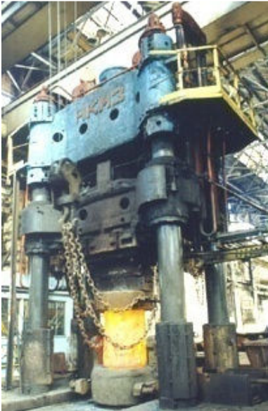
Rys. 8.8 Prasy hydrauliczne z korpusami: a) kolumnowym o nacisku 40000 kN, b) stojakowa o nacisku 2500 kN [43, 61]
