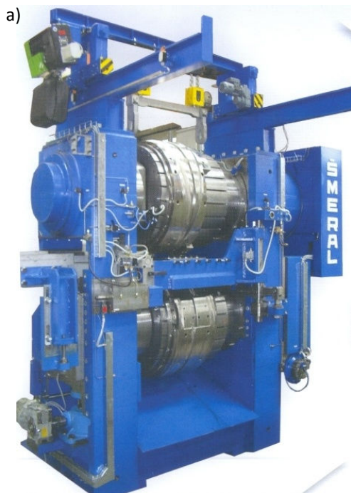
Rys. 11.6. Nowoczesna walcarka poprzeczna, wykorzystywana w procesach WPK firmy Šmeral – a), oraz schemat walcowania poprzeczno-klinowego dwoma walcami – b) [22, 72]
