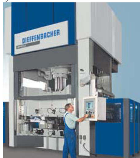
Rys. 36. Prasy hydrauliczne stosowane do: a) prostowania grubych płyt, b) tłoczenia blach karoseryjnych [71, 52]
