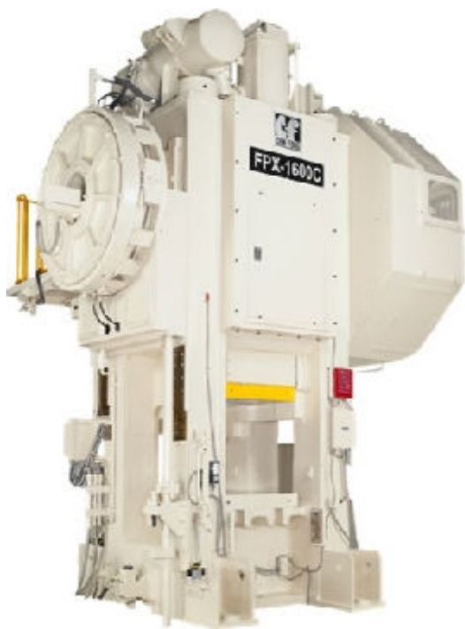
Rys. 7.21. Kuźnicza prasa korbowa o nacisku 160 MN oraz przykładowe odkuwki kształtowane na prasach kuźniczych [57, 37]
