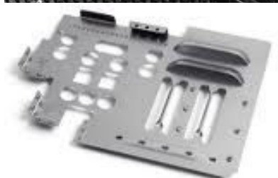
Rys. 9.1. Elementy kształtowane na wykrawarkach CNC: a) widok wykrawarki wraz z wycinanymi elementami, b) wykrawane elementy [62, 77]
