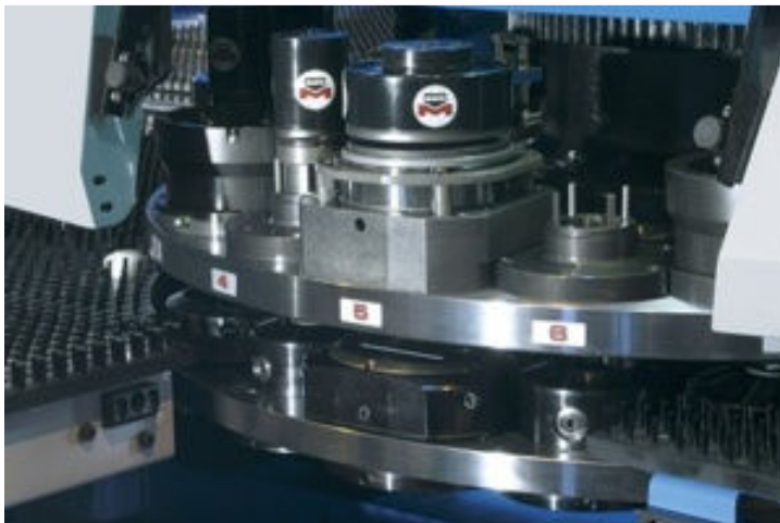
Rys. 9.7. Wykrawarka CNC firmy FINN POWER serii E6 z serwonapędem elektrycznym suwaka z rewolwerowym magazynem narzędzi – a) oraz widok rewolwerowego magazynu narzędzi – b)
