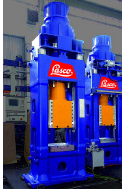
Rys. 6.24. Prasa śrubowa z napędem elektrycznym bezpośrednim firmy LASCO [35, 30]
