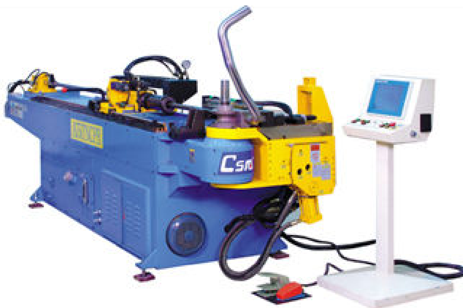
Rys. 11.23. Giętarka trzpieniowa do rur i kształtowników zamkniętych A 100 TNCPB, sterowana numerycznie firmy CSM [55]
