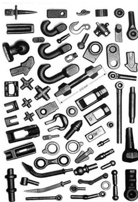
Rys. 7.21. Kuźnicza prasa korbowa o nacisku 160 MN oraz przykładowe odkuwki kształtowane na prasach kuźniczych [57, 37]
