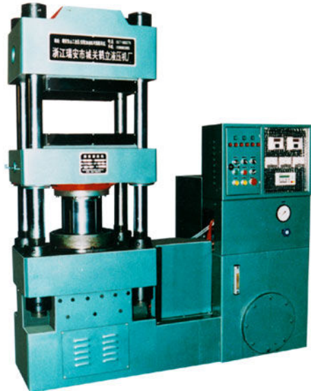
Rys. 8.3. Prasa z napędem hydraulicznym dolno cylindrowa: a) schemat i zasada działania, b) przykładowa konstrukcja prasy o nacisku 2500 kN [56]
