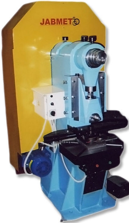
Rys. 4.3. Prasa mimośrodowa stała o nacisku 63 kN z wałem korbowym usytuowanym prostopadle do przodu prasy, jednostronnie łożyskowanym firmy JABMET [65]
