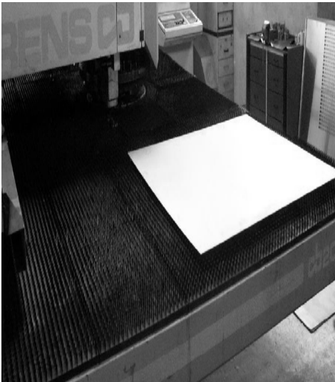
Rys. 9.4. Konstrukcja stołów stosowanych w wykrawarkach CNC: a) szczotkowy, b) kulowy [59, 76]
