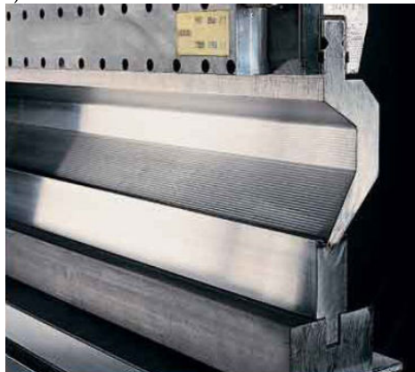
Rys. 7.40. Automatyczne systemy mocowania stempli stosowane w prasach BYSTRONIC: a) pneumatyczne, b) hydrauliczne [25]
