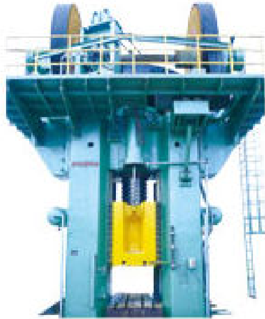
Rys. 6.11. Prasa śrubowa z napędem ciernym dwutarczowym o nacisku 25000kN [66]
