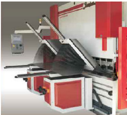
Rys. 7.39. Ramiona śledzące stosowane w prasach krawędziowych firmy BYSTRONIC do podparcia giętego półfabrykatu [25]
