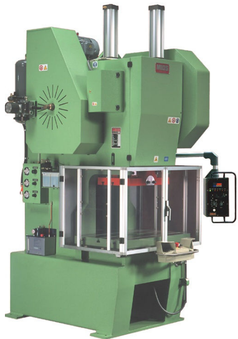
Rys. 4.8. Prasa mimośrodowa stała o nacisku 1050 kN z wałem dwustronnie łożyskowanym usytuowanym równoległe do przodu prasy firmy MIOS [42]
