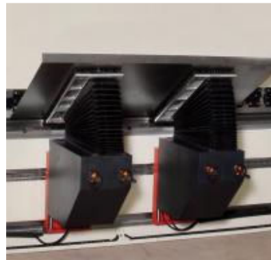
Rys. 7.39. Ramiona śledzące stosowane w prasach krawędziowych firmy BYSTRONIC do podparcia giętego półfabrykatu [25]
