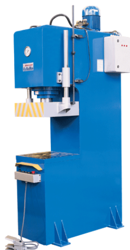
Rys. 8.9 Prasy hydrauliczne z korpusami: a) ramowym o nacisku 16000 kN, b) wysięgowym o nacisku 1000 kN [41, 67]
