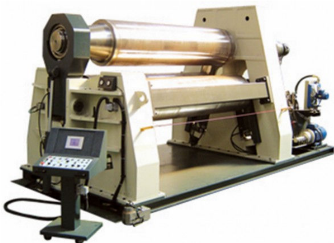
Rys. 11.16. Giętarka trójwalcowa z napędem mechanicznym walców i hydrauliczną regulacją położenia walców sterowana CNC [53]
