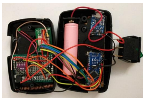
Rys. 10. Nadajnik – widok wewnętrznych podzespołów
