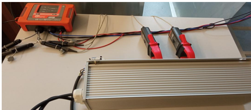
Rys. 2. Wygląd stanowiska do badania jakości energii
