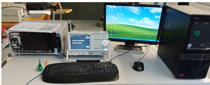
Rys. 3. Wygląd stanowiska do badania kompatybilności elektromagnetycznej
