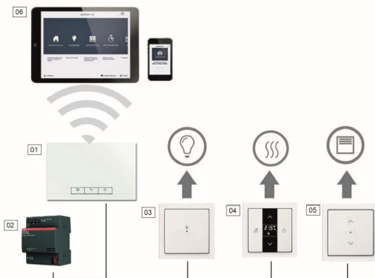
Rys. 4. Ogólny schemat połączenia systemu: 01 – System Access Point; 02 – Zasilacz systemowy; 03 – Sensor oświetlenia; 04 – Sensor sterowania temperaturą; 05 – Sensor sterowania żaluzjami; 06 – Urządzenia sterowania mobilnego [20]
