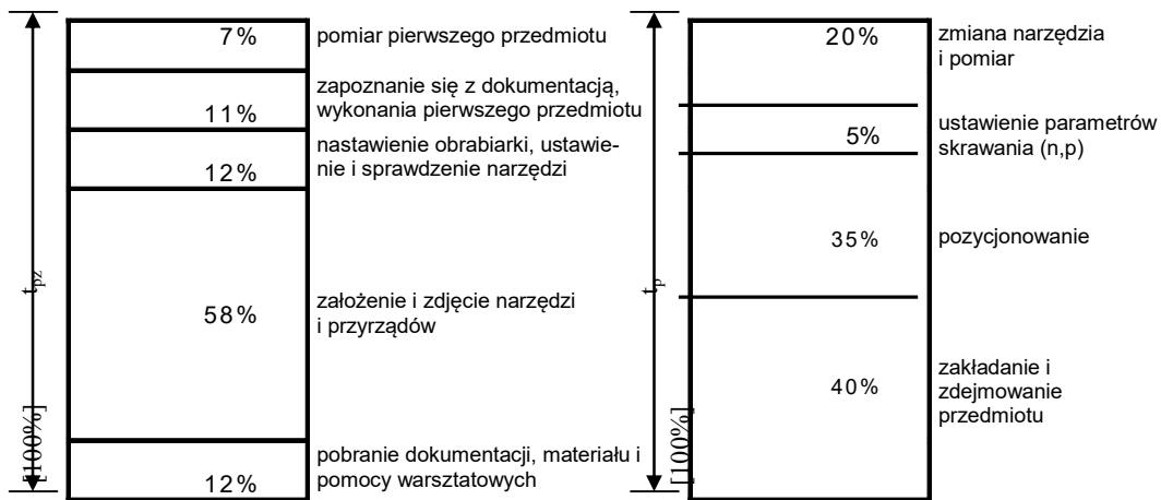
Rys. 2. Struktura czasów przygotowawczo-zakończeniowego ( t_{pz} ) i pomocniczego ( t_p )
