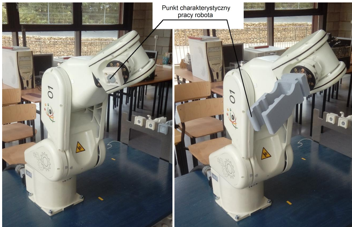
Rys. 2. Położenie punktu charakterystycznego robota: na kiści dla robota nieuzbrojonego i z chwytakiem.
