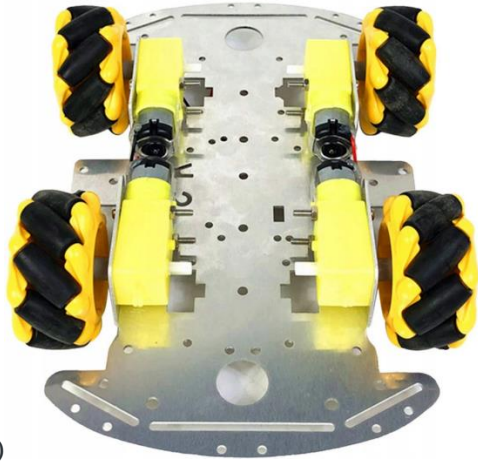
Rys. 13. Podwozie z kołami dookólnymi, a) podwozie, b) części składowe podwozia pojazdu (allegro.pl)
