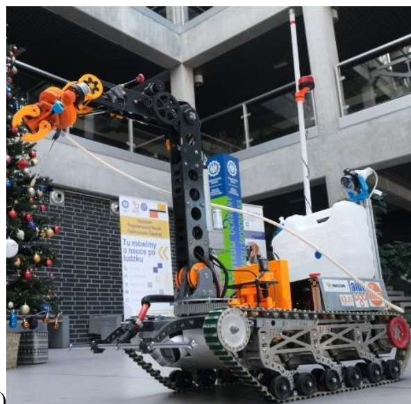
Rys. 14. Roboty mobilne na podwoziu gąsienicowym, a) robot patrolowo-przenośny do sił zbrojnych RP – PIAP Warszawa, b) robot dezynfekujący Politechnika Śląska
