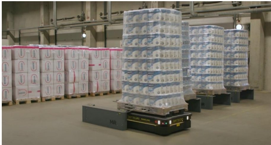
Rys. 6. Dokowanie robota z paletą do stacji zdawczo-odbiorczej ( https://www.youtube.com/watch?v=09lx4jQud8U&t=31s )
