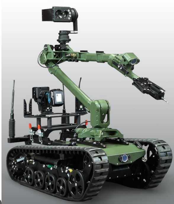
Rys. 14. Roboty mobilne na podwoziu gąsienicowym, a) robot patrolowo-przenośny do sił zbrojnych RP – PIAP Warszawa, b) robot dezynfekujący Politechnika Śląska
