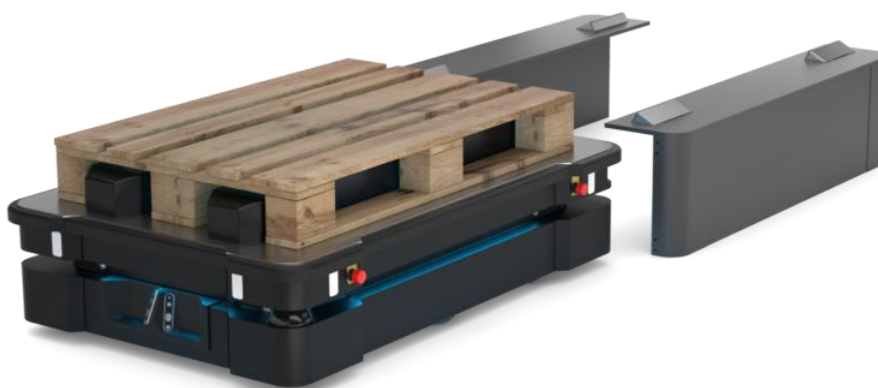
Rys. 5. Robot MiR do przewozu palet i stacja zdawczo-odbiorcza (astor.com.pl)
