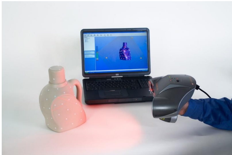
Rys. 4. Widok pracującego Zscannera 700, na zdjęciu widoczna siatka markerów na przedmiocie i zrzut ekranu programu skanującego [36]
