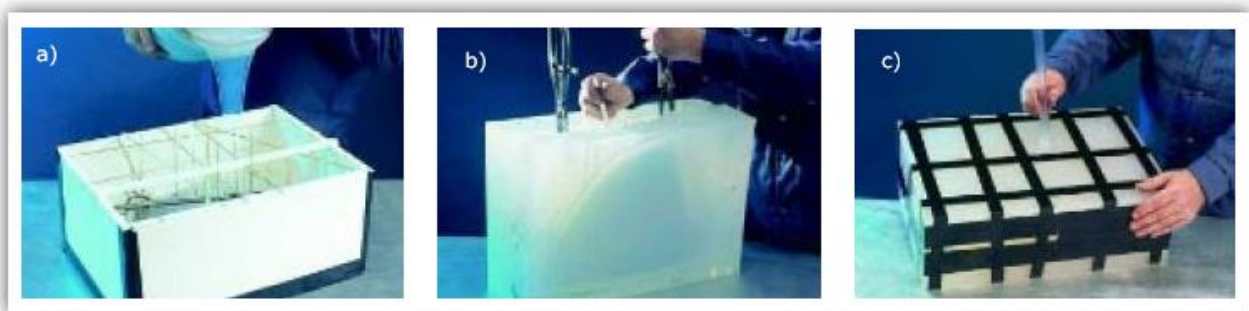
Rys. 36. Zdjęcia z trzech etapów budowania formy: zalewanie formy z ustalonym modelem wzorcowym (a), rozcinięcie formy (b) i ustalanie otworów odpowietrzających (c) [46].
