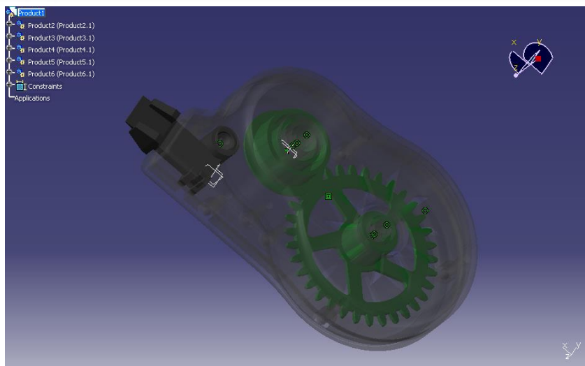
Rys. 80. Widok ogólny złożenia w module AssemblyDesign programu CATIA V5 z zastosowaniem przypisania materiałów do części urządzenia
