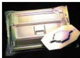
Rys. 49. Złożony zespół form (po lewej) i przykładowe elementy wykonane na takiej formie [46]
