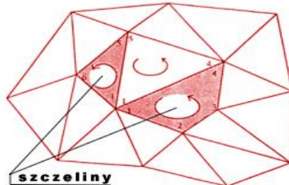
Rys. 8. Szczeliny i luki geometryczne pomiędzy płatkami modelu [53].
