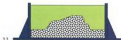
Rys. 46. Zalanie modelu żywicą i piaskiem [46]
