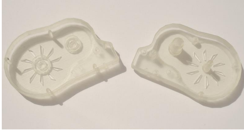
Rys. 99. Dwie połowy obudowy korektora wykonane w procesie PolyJet z materiału FullCure 720
