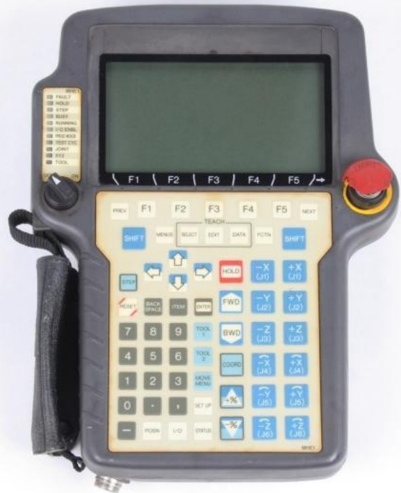
Rys. 3. TeachPendant: a) wirtualny w programie Roboguide, b) rzeczywisty
