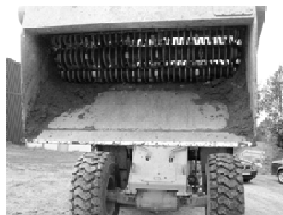
Rys. 1. Łyżka przesiewająco-krusząca stosowana do przygotowania materiału podstawowego.
