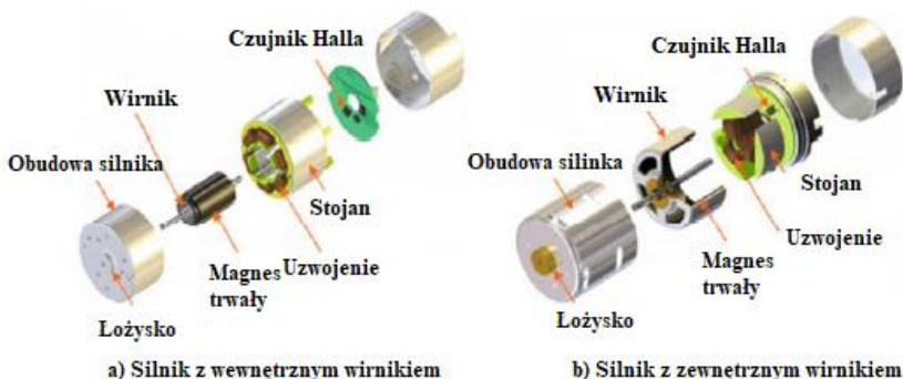
Rys. 2. Zestawienie konstrukcji silników BLDC a) o wewnętrznym wirniku i b) o zewnętrznym wirniku [1]
