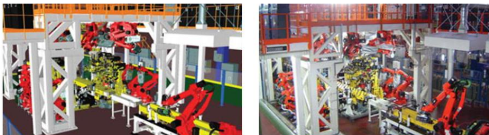
Rys. 1. Implementacja Digital Twin (po lewej Digital Twin, po prawej rzeczywista fabryka)[5]
