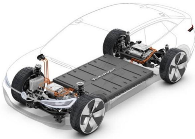
Rys. 2. Schemat napędu samochodu elektrycznego ( http://www.elektroonline.pl/a/10486,Czy-jestesmy-gotowi-na-elektryczne-samochody,," data-bbox="145 441 850 474">Elektrotechnika )
