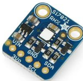
Rys. 7. Cyfrowy czujnik wilgotności i temperatury I2C-Adafruit 3251 [12]
