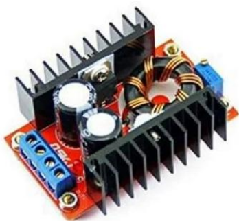
Rys. 1. Przetwornica typu step-up/step-down z widocznymi elementami pasywnymi [5]
