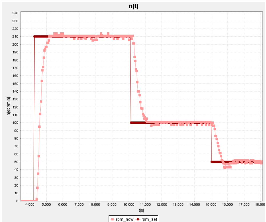
Rys. 22. Wykres prędkości obrotowej w funkcji czasu dla regulatora PI
